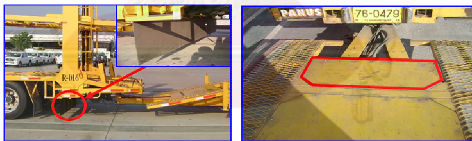
รูปที่ 4.11 แสดงตำแหน่งบังโคลนล้อและแผ่นเหล็กที่พื้นรถเทรลเลอร์ ก่อนการปรับปรุง
