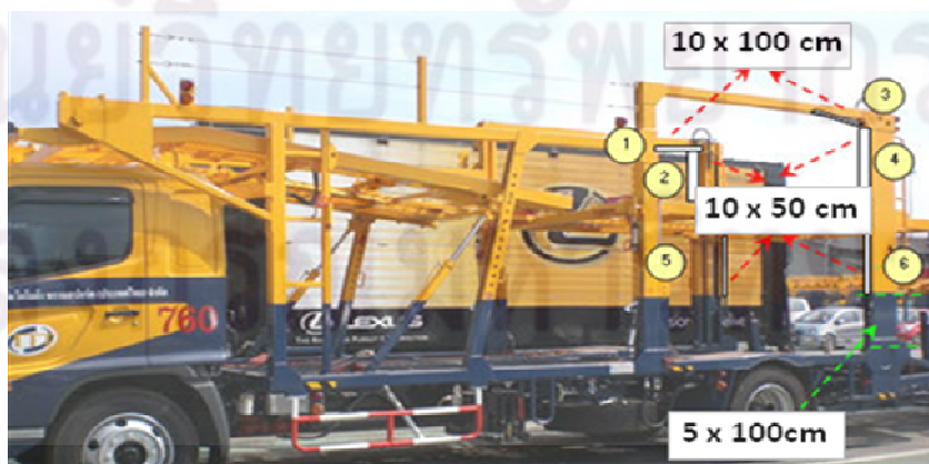
รูปที่ 4.18 แสดงจุดติดตั้งแผ่นโคมกันกระแทกที่เสารถเทรลเลอร์
