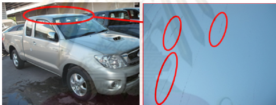
รูปที่ 4.21 แสดงปัญหาลงคาบุงโดนกิ่งไม้ภายหลังใช้อุปกรณ์ป้องกันการกระแทกที่หลังคา
