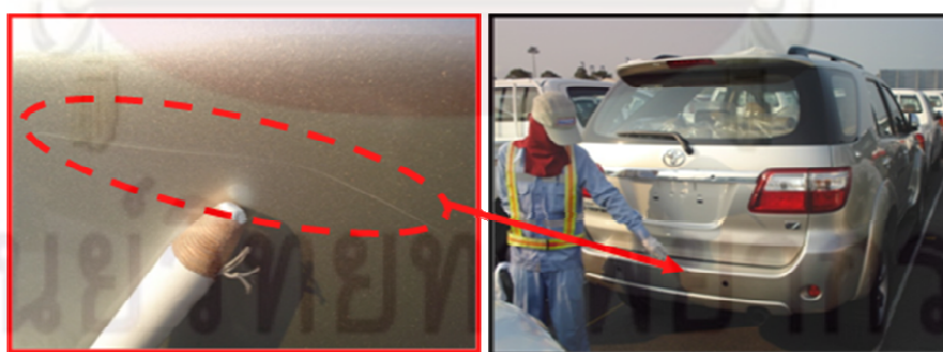
รูปที่ 3.13 รูปแสดงปัญหาก้านชนหลังขีดถลอก
