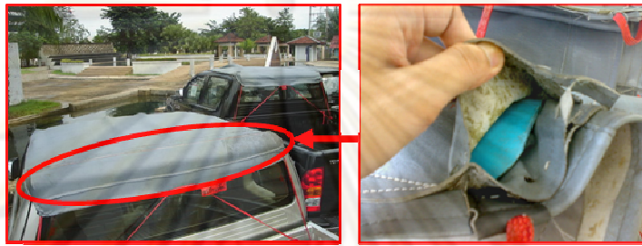
รูปที่ 4.4 ตำแหน่งจุดรถยนต์ที่พบปัญหาหลังคารถใหม่บุบ
