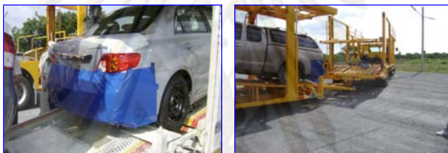
รูปที่ 4.10 แสดงการจำลองการวิ่งทดสอบของรถเทรลเลอร์
