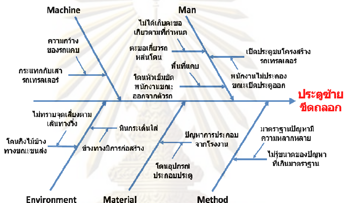
รูปที่ 3.9 แผนผังก้างปลาแสดงสาเหตุของประตูซ้ายขีดถลอก
