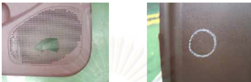
รูปที่ 3.4 ตัวอย่างของการเชื่อมไม่เต็ม และ ตัวอย่างของรอยต่างขา
