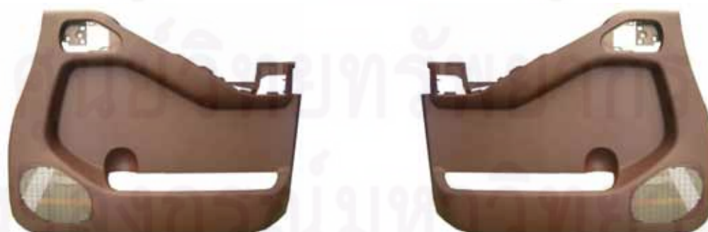
รูปที่ 3.3 ตัวอย่างชิ้นงานแผงประตูหน้าด้านขวาและซ้ายของรถบรรทุกขนาด 1 ตัน
