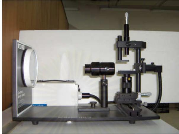
รูปที่ 3.3 เครื่องวัดมุมสัมผัสของน้ำ (contact angle meter)
