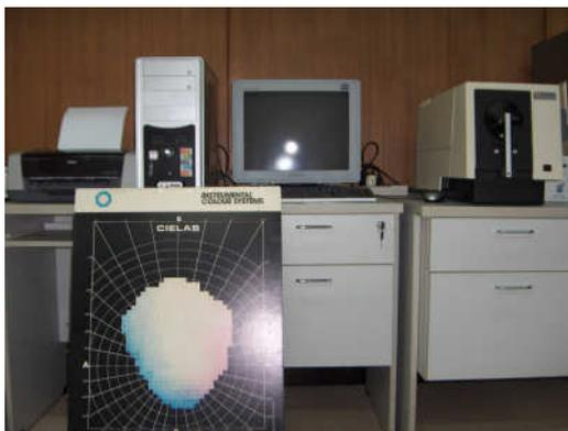
รูปที่ 3.7 เครื่องวัดสี (spectrophotometer)
