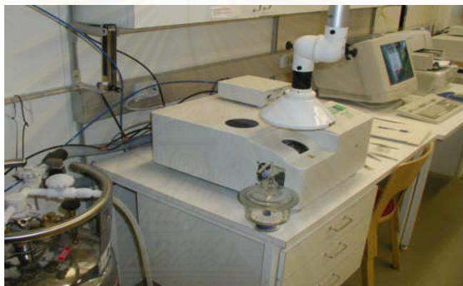
รูปที่ 3.11 เครื่องวิเคราะห์ทางความร้อน (DSC)
