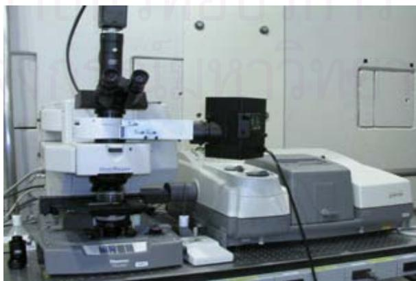
รูปที่ 3.10 เครื่องวิเคราะห์ทางสเปกโทรสโกปีด้วยรังสีอินฟราเรด (ATR-FTIR)
