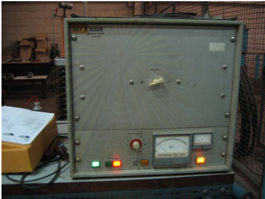
รูปที่ 3.25 เครื่องกำเนิดแรงดันเสิร์จมาตรฐาน 1.2/50 \mu s ในห้องปฏิบัติการไฟฟ้าแรงสูง
