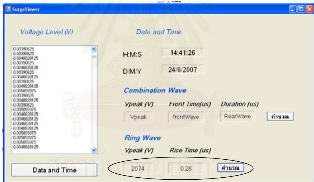
รูปที่ 3.24 แสดงผลการคำนวณค่าพารามิเตอร์ ของแรงดันเล็จร้จมาตรฐาน Ring Wave
