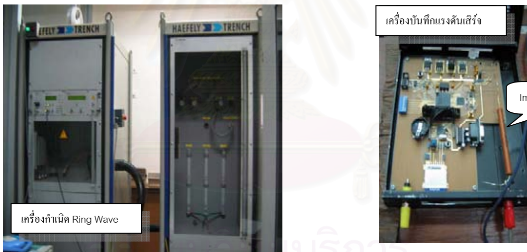
รูปที่ 4.24 วงจรทดสอบเครื่องบันทึกแรงดันเสิร์จ
