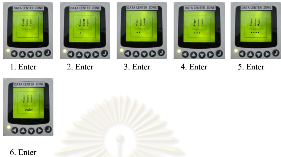
รูปที่ 4.3 ส่วนต่อประสานกับผู้ใช้ในการใส่รหัสผ่าน สำหรับงานยกเลิกและตรวจสอบความร้อน
