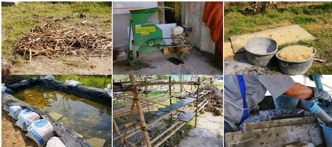
ภาพที่ 3.21 ขั้นตอนการผลิตวัสดุท้องถิ่นสมัยใหม่ วัสดุผนังซีเมนต์จากไผ่ไมยราพยักษ์
