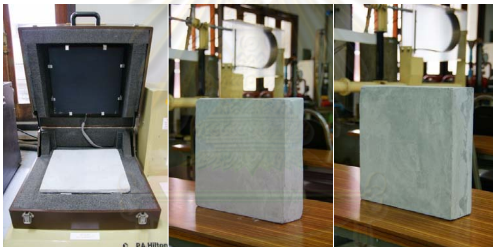
ภาพที่ 3.27 วัสดุที่เตรียมสำหรับการทดสอบ จากซ้าย ไป ขวา วัสดุผนังซีเมนต์ใยไมยราพยักษ์ อิฐดินเบาลำปาง อิฐจากซีเมนต์ลอยแม่เมาะ
