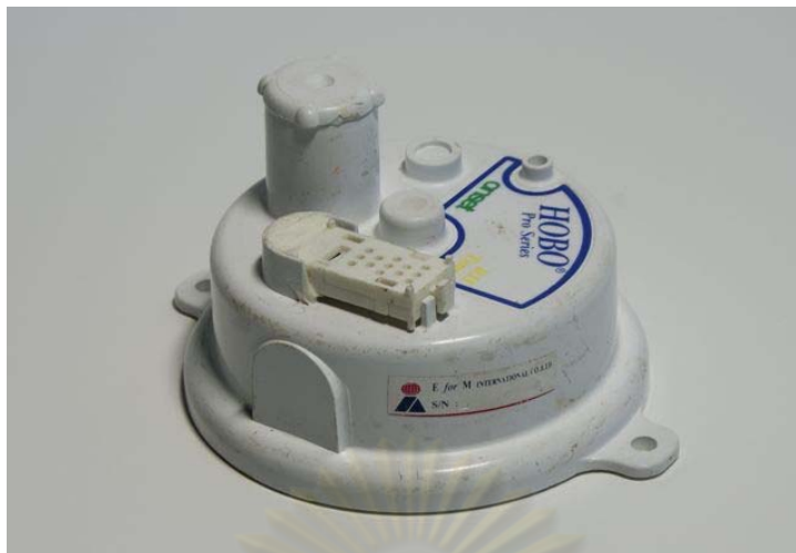
ภาพที่ 3.15 อุปกรณ์ data logger สำหรับเก็บข้อมูลอุณหภูมิอากาศและความชื้นสัมพัทธ์ ภายนอกเรือน ยี่ห้อ HOBOTM รุ่น pro data logger HO8-032-08
