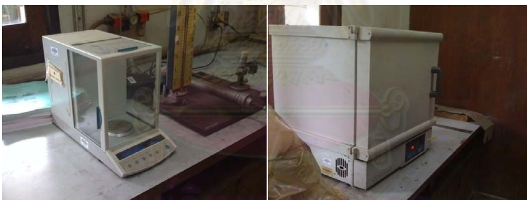
ภาพที่ 3.28 เครื่องชั่งน้ำหนักชนิดละเอียด เครื่องอบวัสดุ เพื่อหาค่าความชื้นของวัสดุ
