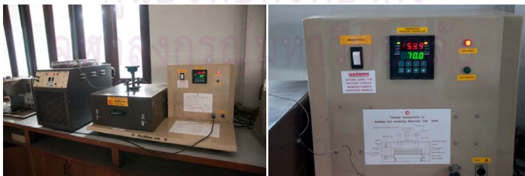
ภาพที่ 3.26 เครื่องมือสำหรับทดสอบคุณสมบัติการต้านทานความร้อน (k) ของวัสดุ
