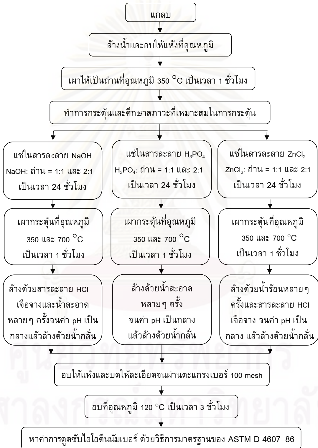
รูปที่ 3.1 กระบวนการผลิตถ่านกัมมันต์จากแกลบ
