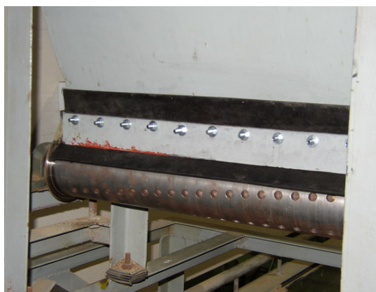
รูป ข-5 ภาพแผ่นยางเครื่องโรยทราย ก่อน-หลัง การปรับปรุง
