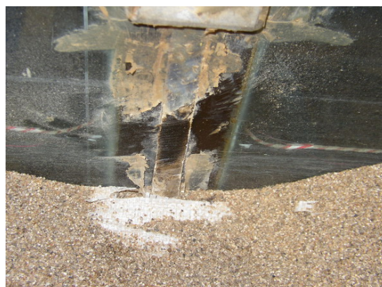
รูป ข-4 ภาพรอยขรุขระผนังด้านข้างรางน้ำ ก่อน-หลัง การปรับปรุง
