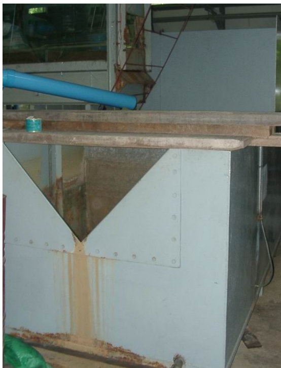
รูป ก-7 ฝายสามเหลี่ยมวัดน้ำสันคม
