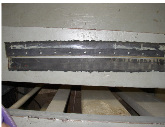
รูป ข-5 ภาพแผ่นยางเครื่องโรยทราย ก่อน-หลัง การปรับปรุง
