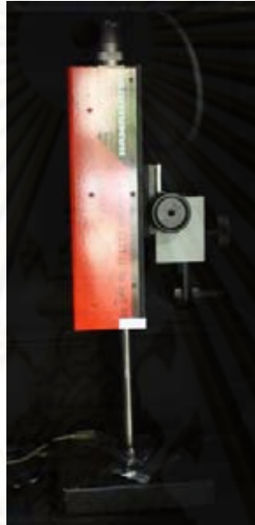
รูปที่ 3.1 เครื่องกำเนิดรังสีเอกซ์แบบไมโครโฟกัส
