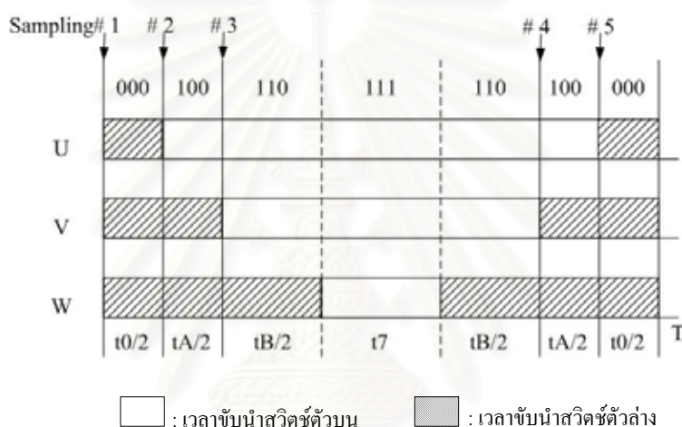
รูปที่ 3.9 ตำแหน่งในการสุ่มค่ากระแสเมื่อเวกเตอร์คำสั่งอยู่ในเซกเตอร์ที่ 1 และสัญญาณขับนำสวิตช์เมื่อไม่มีเวลาประวิงใน 1 คาบการสวิตช์
