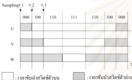
รูปที่ 4 ตำแหน่งในการสุ่มค่าเมื่อเวกเตอร์คำสั่งอยู่ในเซกเตอร์ที่ 1 และสัญญาณชับนำสวิตช์เมื่อไม่มีเวลาประวิงใน 1 คาบการสวิตช์
