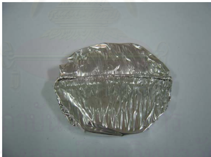
รูปที่ 3.12 การฉีก Mn-fiber หลังจากทำการเผาแล้ว
