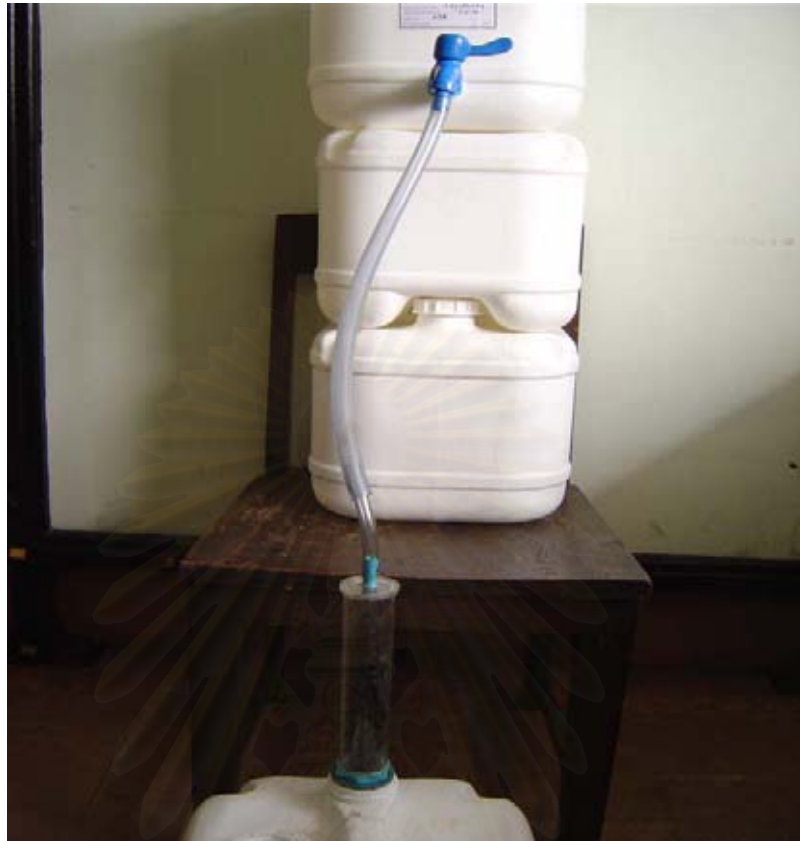
รูปที่ 3.9 การเก็บตัวอย่างน้ำโดยผ่าน Mn-fiber
