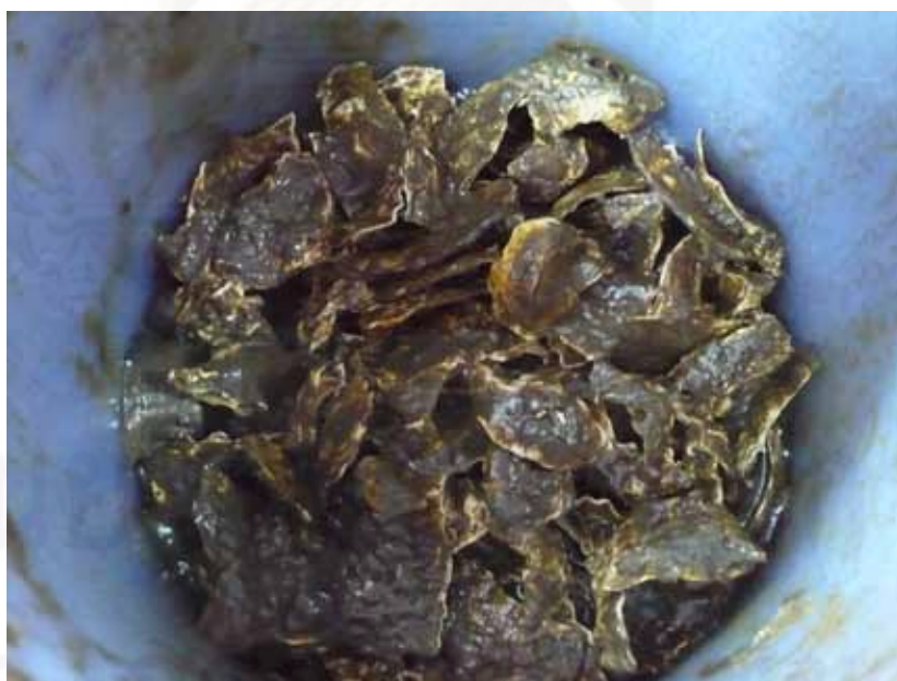
รูปที่ จ-4 ลักษณะของเปลือกหอยนางรมหลังใช้ในระบบบำบัดด้วยถังกรองไร้อากาศ
