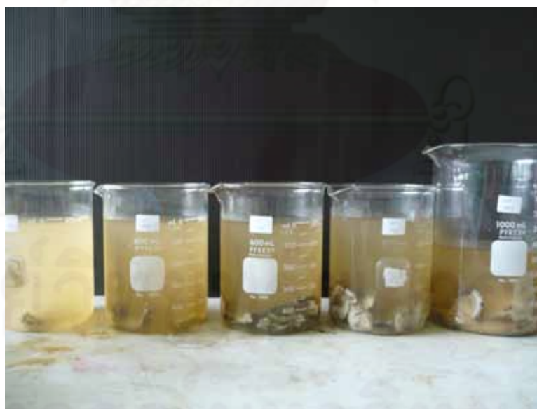
รูปที่ จ-2 การทดลองในการศึกษาประสิทธิภาพในการปรับค่าพีเอช (pH) ของน้ำเสี้ยวที่มีฤทธิ์เป็น กรด ระหว่างตัวกลางเปลือกหอยนางรมที่ไม่ได้เผาและตัวกลางเปลือกหอยนางรมที่เผา ณ อุณหภูมิและเวลาที่เหมาะสม
