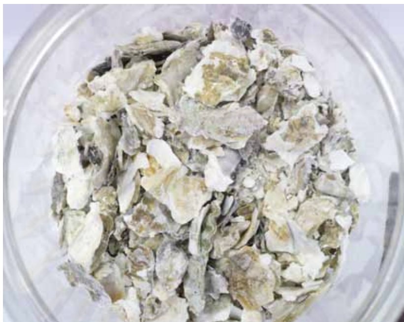
รูปที่ จ-3 ลักษณะของเปลือกหอยนางรมก่อนนำมาใช้ในระบบบำบัดด้วยถังกรองไร้อากาศ
