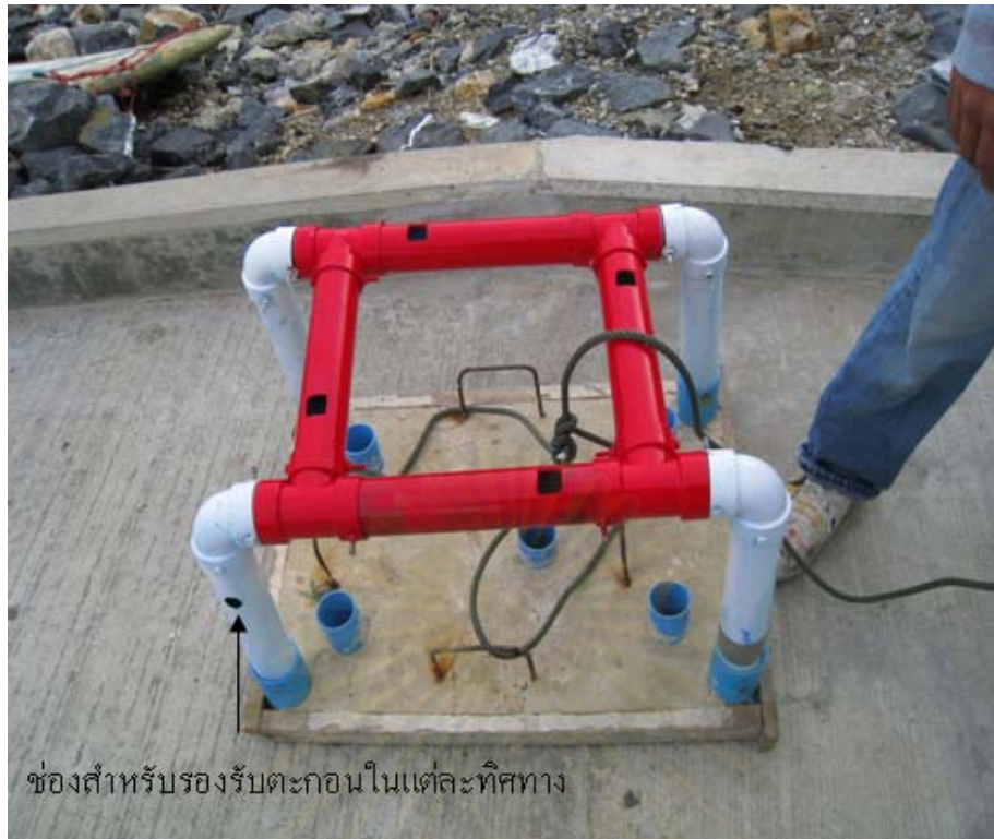
ภาพที่ 10 เครื่องดักตะกอนสำหรับหาอัตราการเคลื่อนตัวของตะกอนแขวนลอยจากแต่ละทิศทาง
