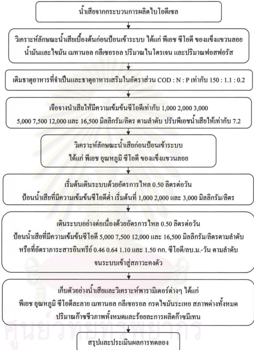
ภาพที่ 3.9 ขั้นตอนการเดินระบบหมักไร้ออกซิเจนแบบสองขั้นตอน
