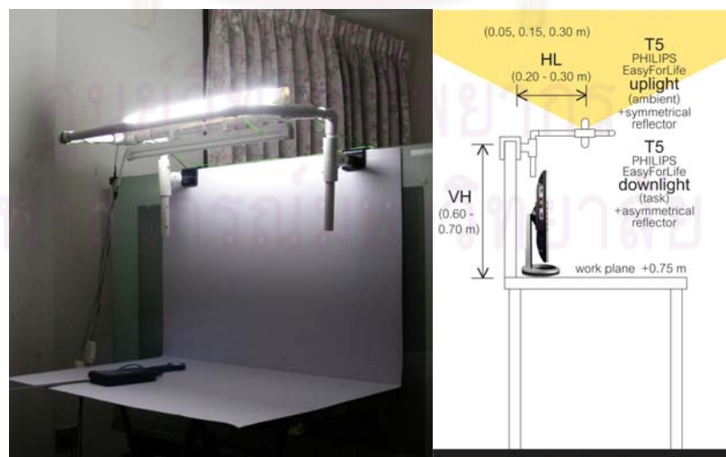
ภาพที่ 3.34 แสดงโคมไฟเท่าขนาดจริงแบบที่ไม่มีตัวกระจายแสง ลักษณะแสงส่องขึ้น
