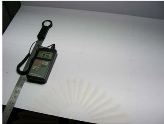
ภาพที่ 3.33 แสดงการวัดค่าการส่องสว่างที่ระนาบทำงานโดยเครื่องมือ DX – 200
