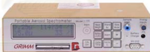
รูปที่ 3.11 เครื่องวัดความเข้มข้นฝุ่นแบบ Real time: Portable Dust Monitoring
