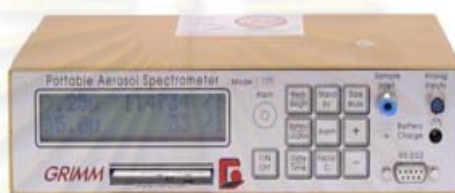
รูปที่ 3.2 เครื่อง Real Time : Portable Dust Monitor ชนิด GRIMM version 1.100 models 1.108
