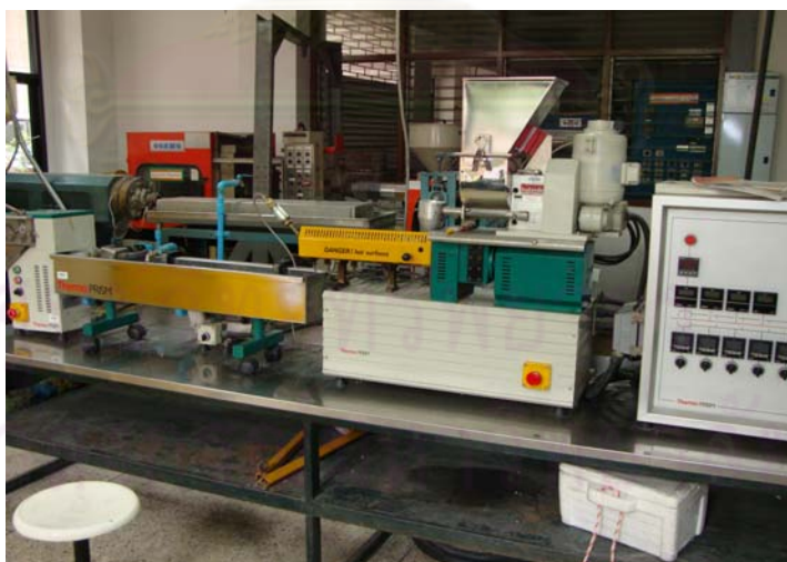
รูปที่ 3.4 เครื่องอัดรีดสกรูคู่
