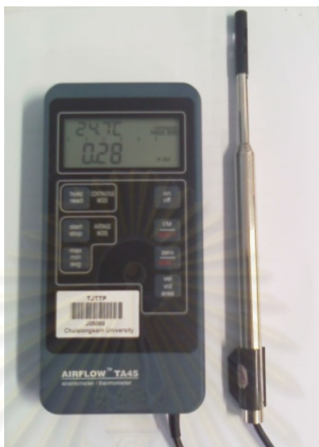
รูปที่ 3.5 Air velocity meter ชนิด hot-wire anemometer (TSI, Inc., model 9555)
