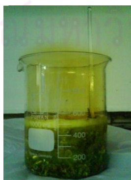
ภาพที่ 3.15 กรดไนตริกขณะทำปฏิกิริยากับโลหะยูเรเนียมด้อยสมรรถนะ
