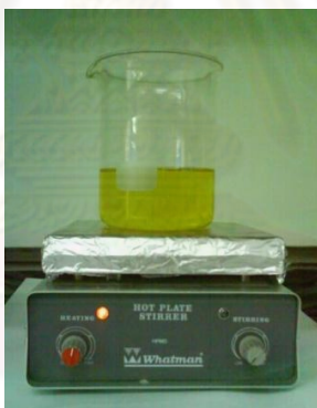
ภาพที่ 3.17 การต้มสารละลายยูเรเนียม
