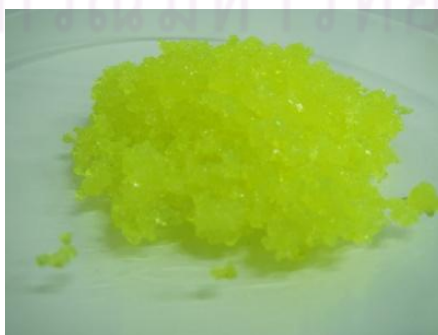
ภาพที่ 3.18 ผลึกยูเรนิลไนเตรทเฮกซะไฮเดรต
