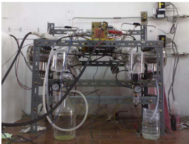
รูปที่ 3.4 ระบบทดสอบสมรรถนะเซลล์เชื้อเพลิง (Test station)
