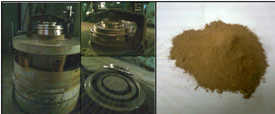
รูปที่ 3.7 ภาพแสดงเครื่องบดแบบถ้วย (Vibrating cup mill) และขนาดตัวอย่างหลังบด
