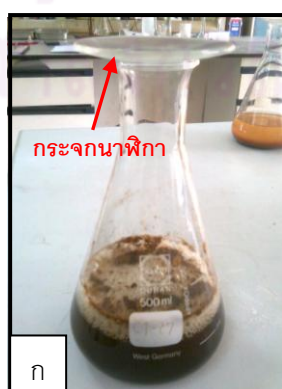
รูปที่ 3.13 แสดงการทดสอบหาค่ากรดต่างสุดท้าย (NAG pH)
