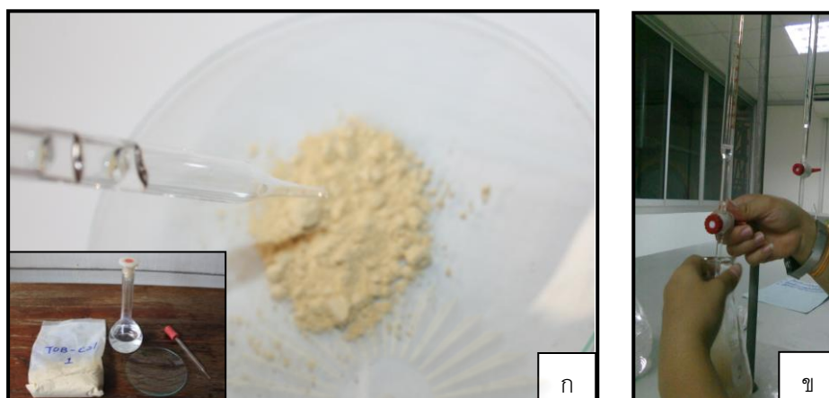
รูปที่ 3.10 แสดงการทดสอบศักยภาพความเป็นกลางของเปลือกดินและขี้เถ้า
