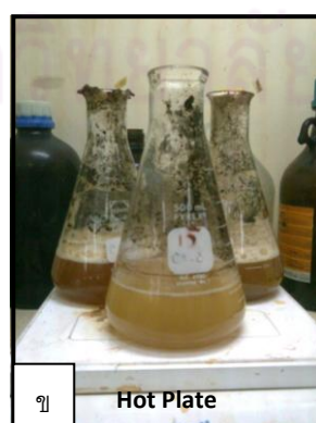
รูปที่ 3.13 แสดงการทดสอบหาค่ากรดต่างสุดท้าย (NAG pH)
