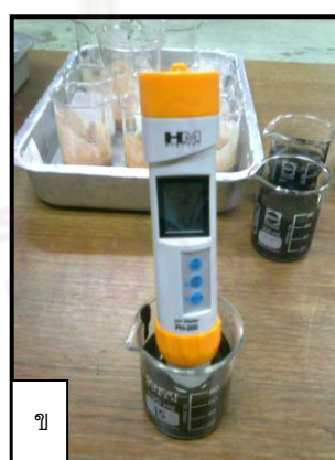
รูปที่ 3.9 แสดงการทดสอบการวัดค่าความเป็นกรดต่าง (pH)
