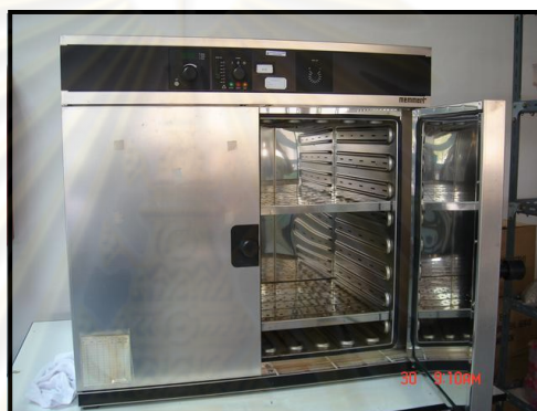
รูปที่ 3.5 ตู้อบที่ใช้ในการอบตัวอย่างให้แห้ง
