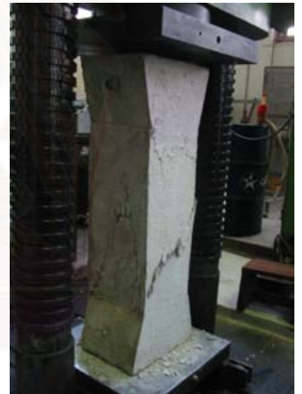
รูปที่ 3.104 แสดงการวิบัติของเสาตัวอย่างที่ 3
