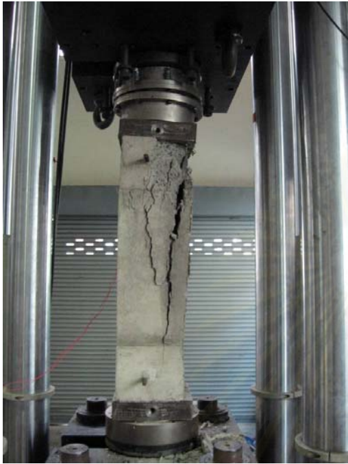
รูปที่ 3.56 แสดงการวิบัติของตัวอย่างเสาหมายเลข 1
