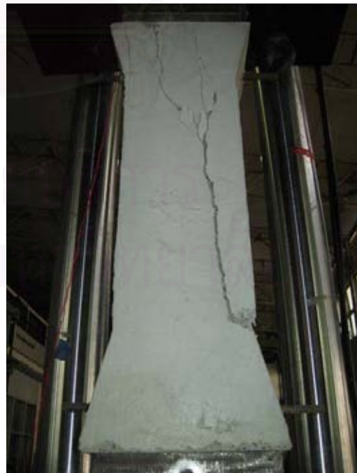
รูปที่ 3.87 แสดงการวิบัติของตัวอย่างเสาหมายเลข 17
