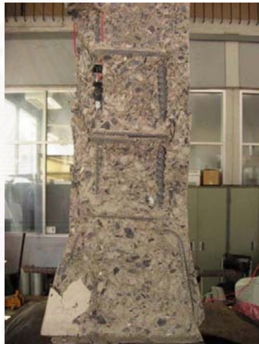
รูปที่ 3.68 แสดงการวิบัติของตัวอย่างเสาหมายเลข 6
