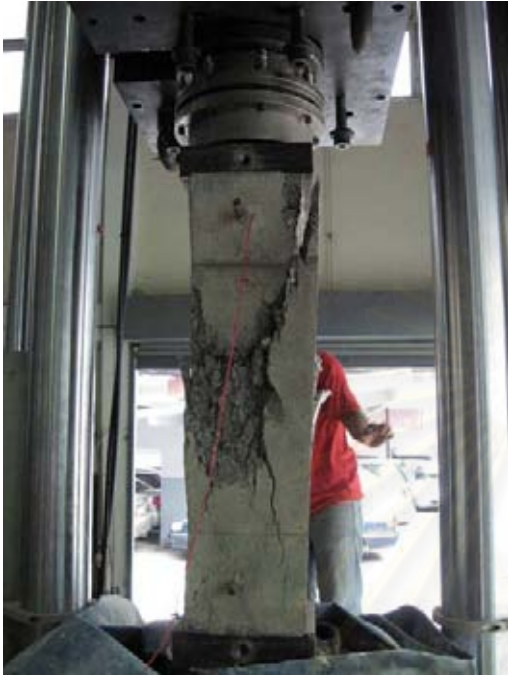
รูปที่ 3.63 แสดงการวิบัติของตัวอย่างเสาหมายเลข 4
