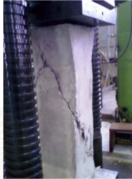
รูปที่ 3.102 แสดงการวิบัติของเสาตัวอย่างที่ 2
