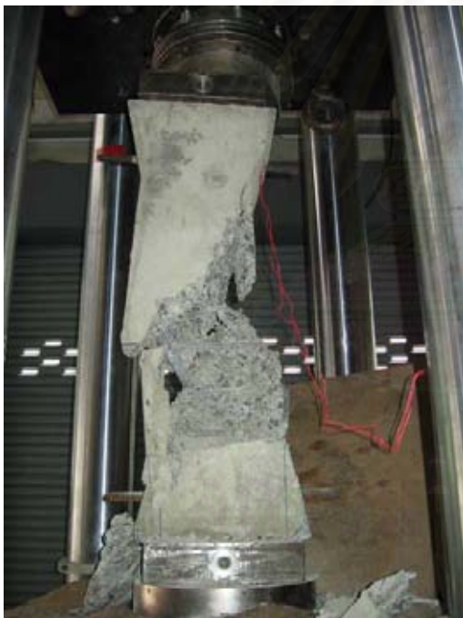
รูปที่ 3.76 แสดงการวิบัติของตัวอย่างเสาหมายเลข 11
