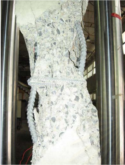
รูปที่ 3.72 แสดงการวิบัติของตัวอย่างเสาหมายเลข 9 รูปที่ 3.73 แสดงการวิบัติของตัวอย่างเสาหมายเลข 9
