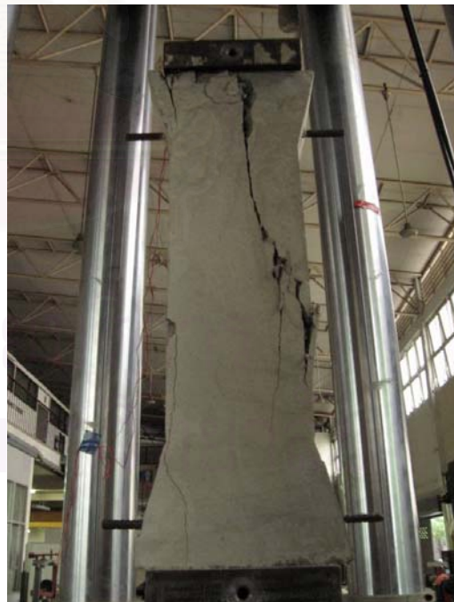
รูปที่ 3.59 แสดงการวิบัติของตัวอย่างเสาหมายเลข 2
