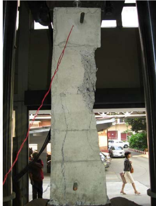
รูปที่ 3.61 แสดงการวิบัติของตัวอย่างเสาหมายเลข 3
