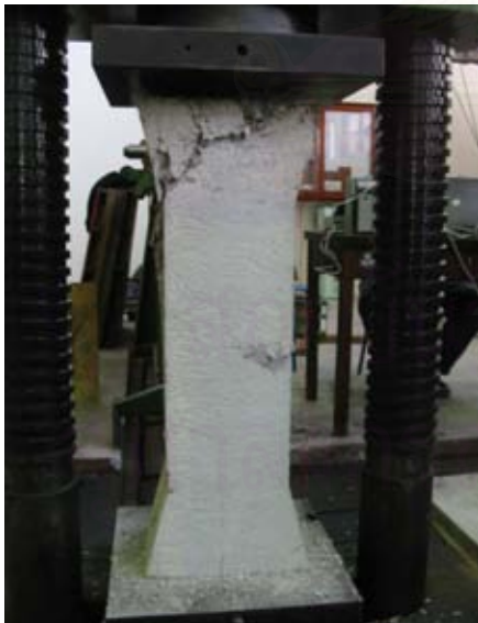
รูปที่ 3.99 แสดงการวิบัติของเสาตัวอย่างที่ 1
