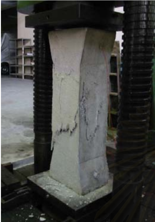
รูปที่ 3.119 แสดงคอนกรีตหุ้มของเสา ตัวอย่างที่ 3 หลังการทดสอบ
