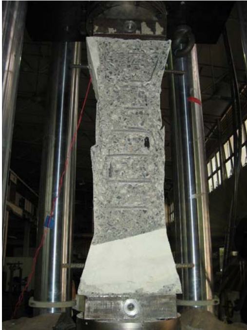
รูปที่ 3.60 แสดงการวิบัติของตัวอย่างเสาหมายเลข 3
