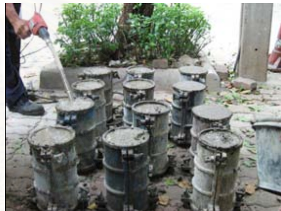
รูปที่ 3.19 การเทคอนกรีตลงในแบบหล่อลูกปุน
