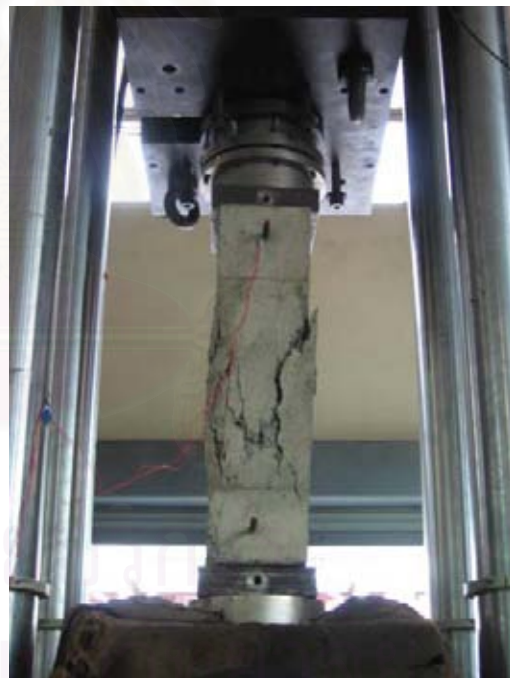
รูปที่ 3.77 แสดงการวิบัติของตัวอย่างเสาหมายเลข 11
