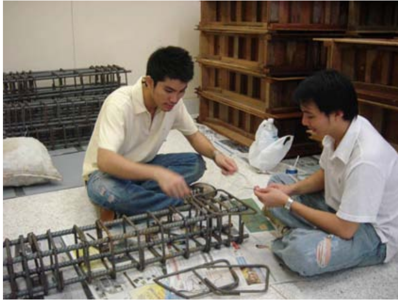
รูปที่ 3.6 การเตรียมเหล็กเสริมที่ใช้ในการทดสอบ
