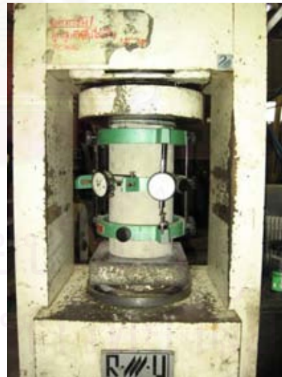
รูปที่ 3.32 การทดสอบกำลังรับแรงอัดของลูกปูน
