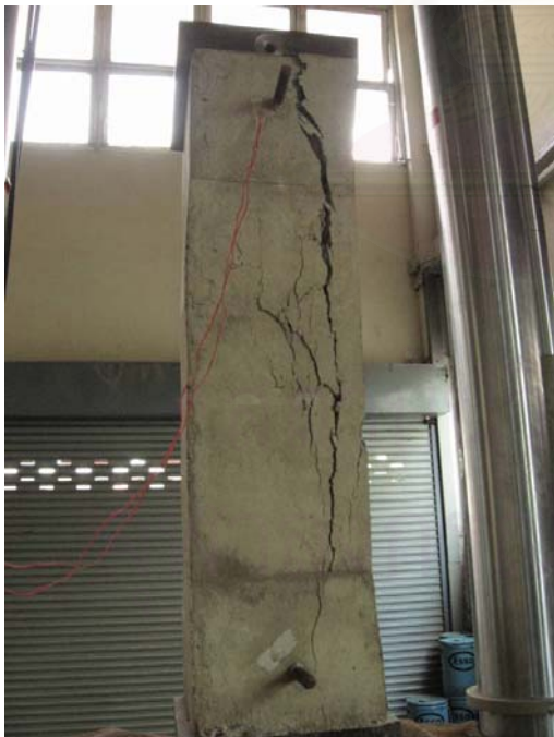
รูปที่ 3.58 แสดงการวิบัติของตัวอย่างเสาหมายเลข 2
