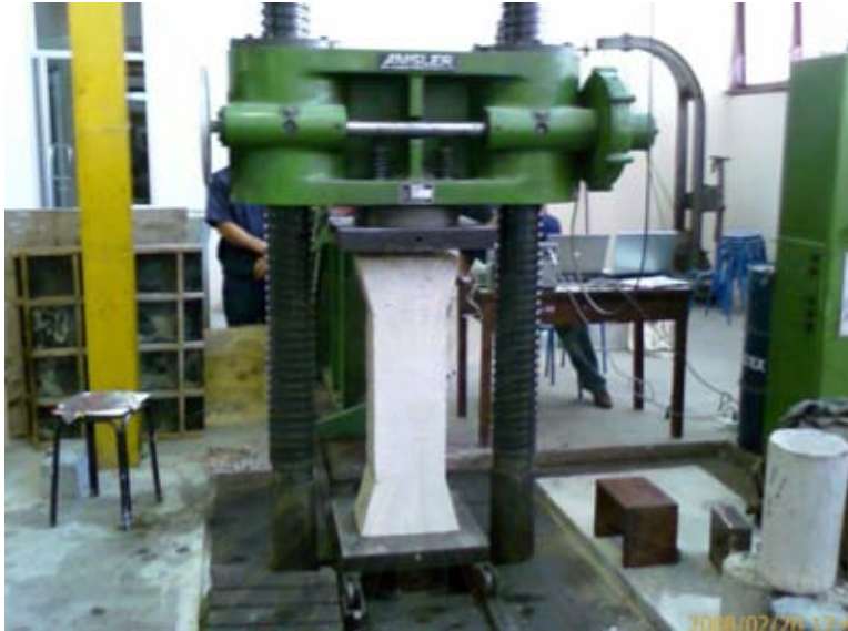
รูปที่ 3.50 การจัดตำแหน่งตัวอย่างเสาไม้ให้ไม่เกิดการเอียงศูนย์
