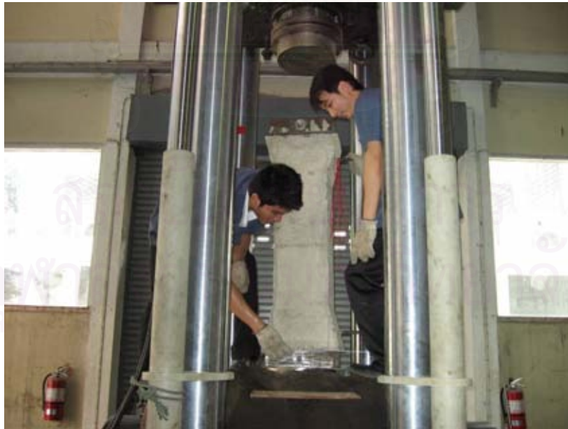
รูปที่ 3.33 การจัดตำแหน่งตัวอย่างเสาไม่ให้เกิดการเอียงศูนย์
