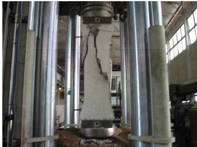
รูปที่ 3.65 แสดงการวิบัติของตัวอย่างเสาหมายเลข 5
