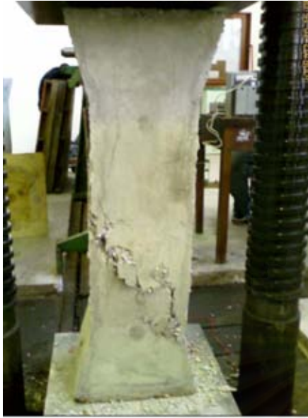
รูปที่ 3.101 แสดงการวิบัติของเสาตัวอย่างที่ 2
