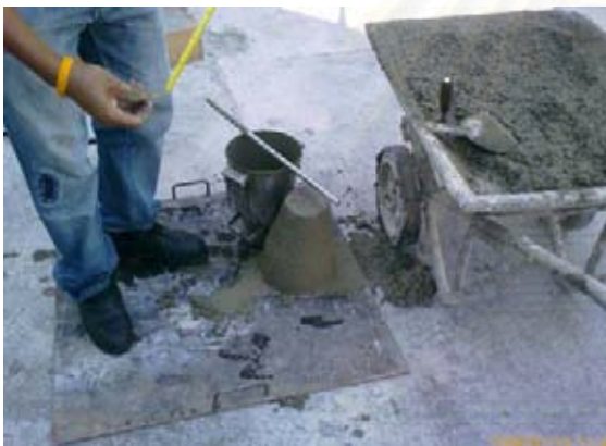
รูปที่ 3.44 การทำ Slump Test
