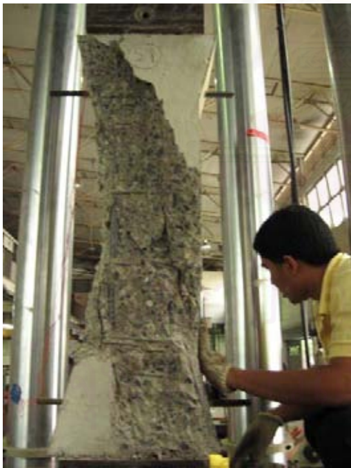
รูปที่ 3.83 แสดงการวิบัติของตัวอย่างเสาหมายเลข 15
