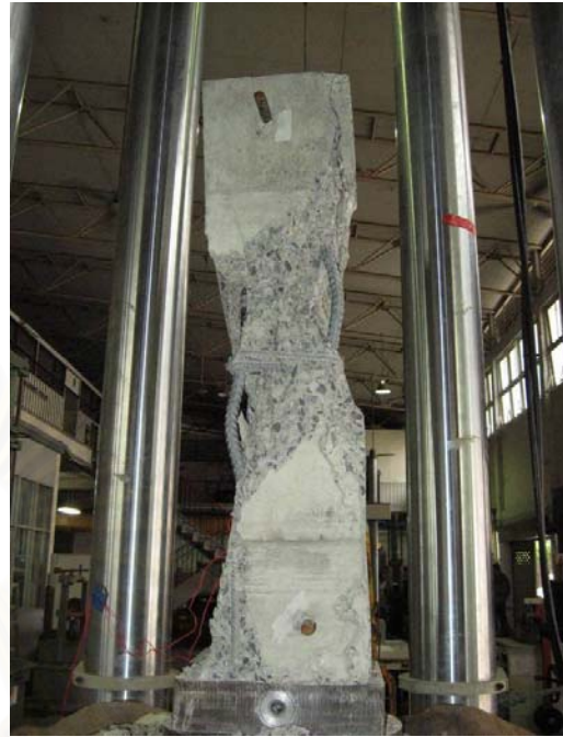
รูปที่ 3.72 แสดงการวิบัติของตัวอย่างเสาหมายเลข 9 รูปที่ 3.73 แสดงการวิบัติของตัวอย่างเสาหมายเลข 9
