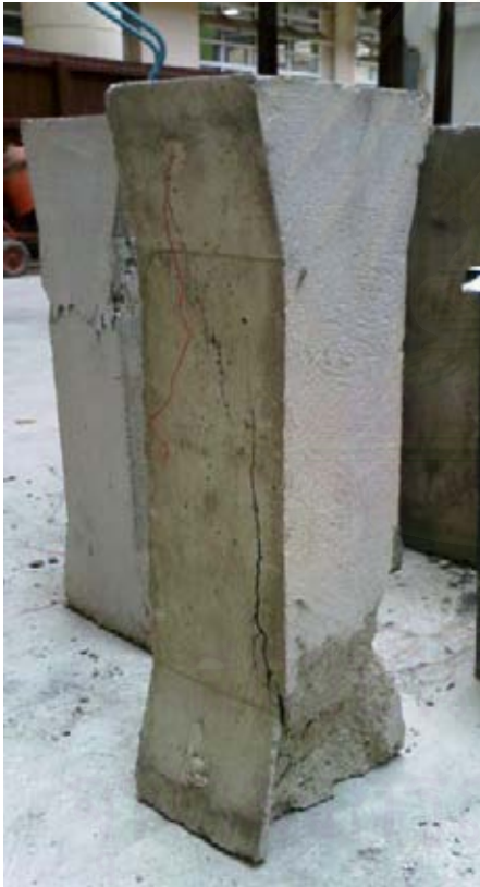
รูปที่ 3.110 แสดงการวิบัติของเสาตัวอย่างที่ 6
