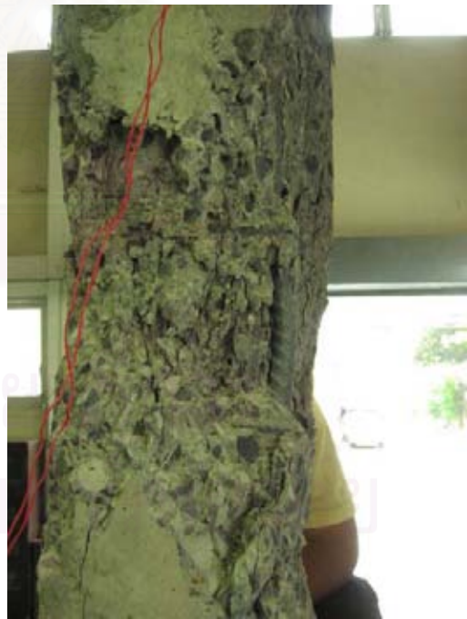
รูปที่ 3.83 แสดงการวิบัติของตัวอย่างเสาหมายเลข 15
