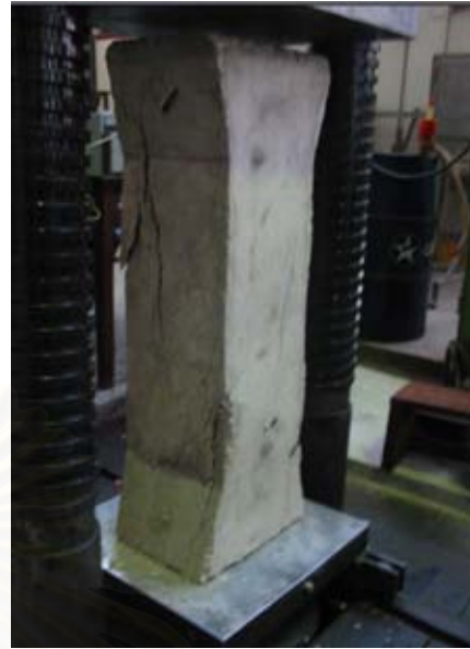
รูปที่ 3.109 แสดงการวิบัติของเสาตัวอย่างที่ 5
