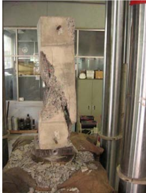
รูปที่ 3.88 แสดงการวิบัติของตัวอย่างเสาหมายเลข 17 รูปที่ 3.89 แสดงการวิบัติของตัวอย่างเสาหมายเลข 18
