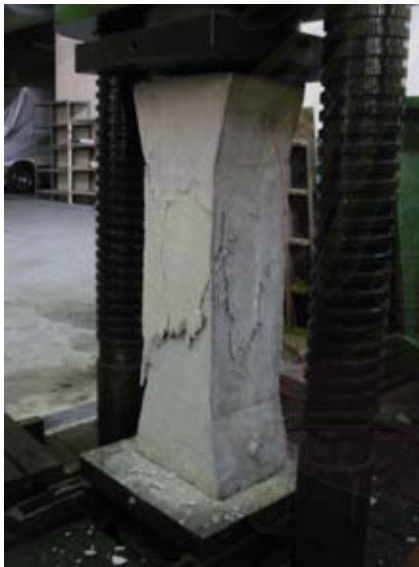
รูปที่ 3.103 แสดงการวิบัติของเสาตัวอย่างที่ 3
