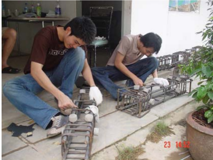
รูปที่ 3.7 การเตรียมผิวบริเวณที่จะติด strain gauge ให้เรียบ
