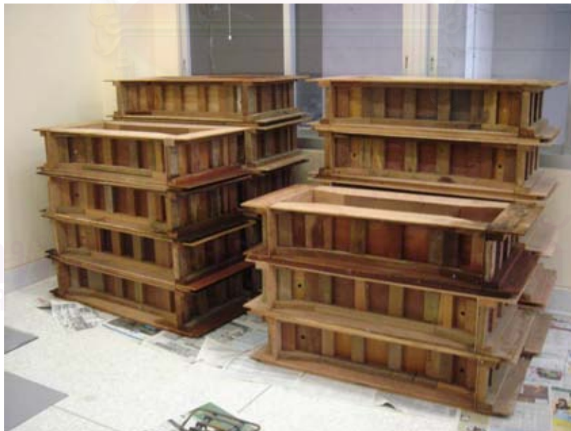
รูปที่ 3.4 แบบไม้สำหรับหล่อตัวอย่างเสาคอนกรีตเสริมเหล็ก
