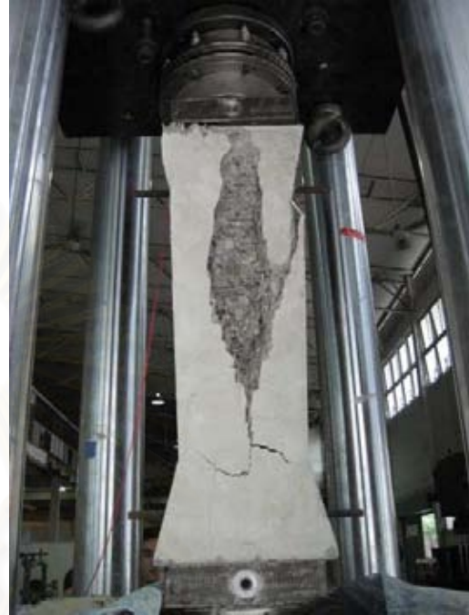
รูปที่ 3.64 แสดงการวิบัติของตัวอย่างเสาหมายเลข 4
