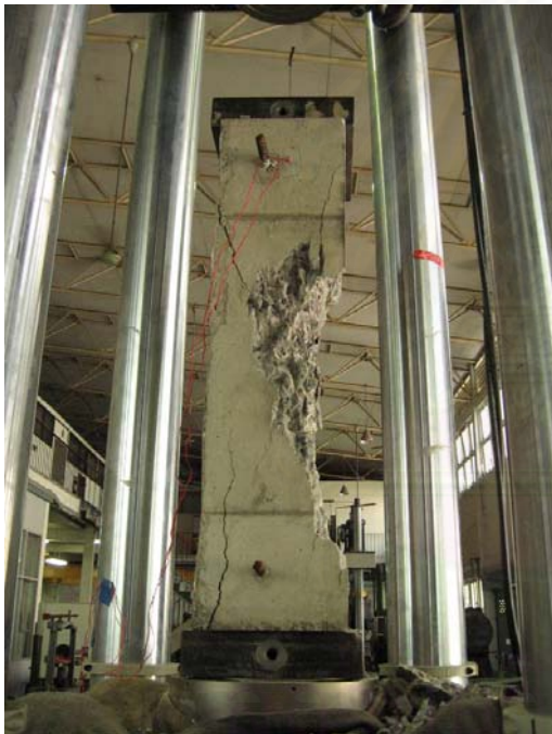
รูปที่ 3.67 แสดงการวิบัติของตัวอย่างเสาหมายเลข 6
