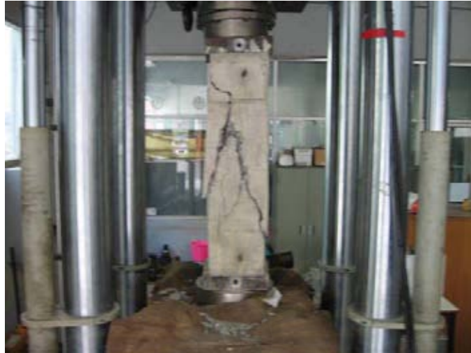
รูปที่ 3.66 แสดงการวิบัติของตัวอย่างเสาหมายเลข 5
