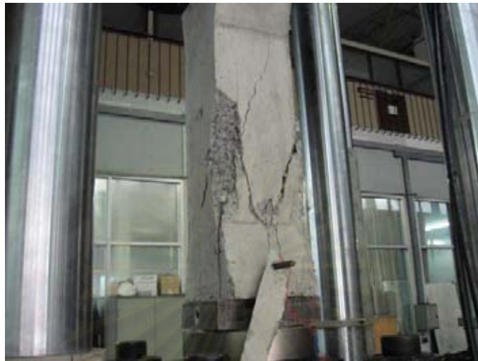
รูปที่ 3.75 แสดงการวิบัติของตัวอย่างเสาหมายเลข 10
