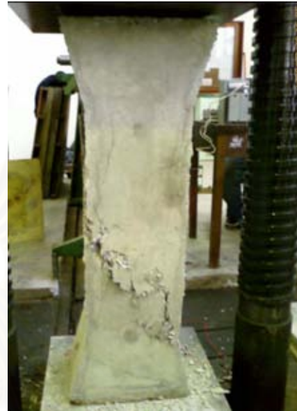
รูปที่ 3.53 เสาตัวอย่างหลังการทดสอบ
