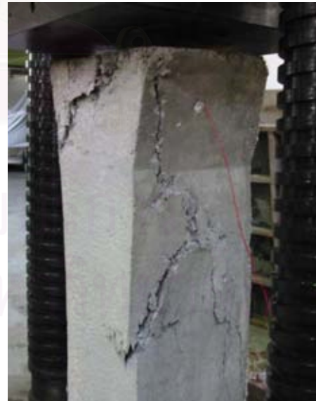
รูปที่ 3.100 แสดงการวิบัติของเสาตัวอย่างที่ 1
