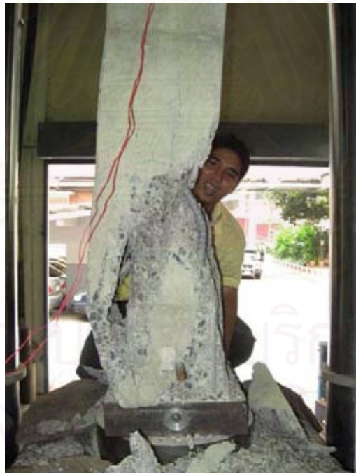
รูปที่ 3.90 แสดงการวิบัติของตัวอย่างเสาหมายเลข 18
