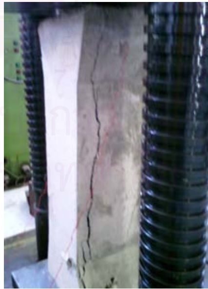
รูปที่ 3.107 แสดงการวิบัติของเสาตัวอย่างที่ 4
