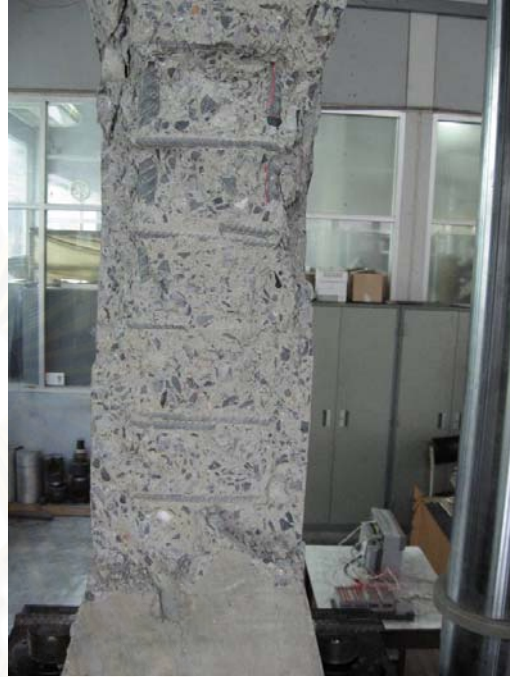
รูปที่ 3.57 แสดงการวิบัติของตัวอย่างเสาหมายเลข 1
