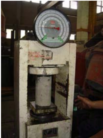
รูปที่ 3.31 การทดสอบกำลังรับแรงอัดของลูกปูน
