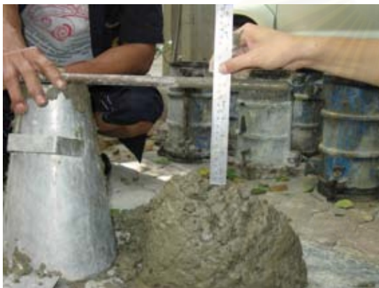
รูปที่ 3.18 การทำ Slump Test
