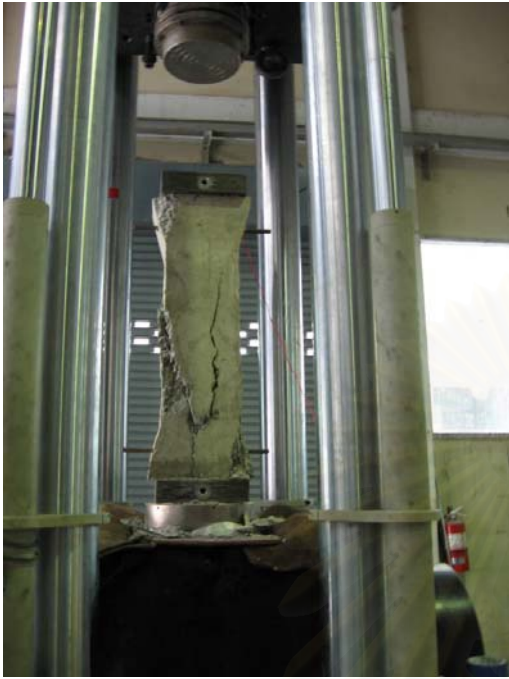
รูปที่ 3.81 แสดงการวิบัติของตัวอย่างเสาหมายเลข 14
