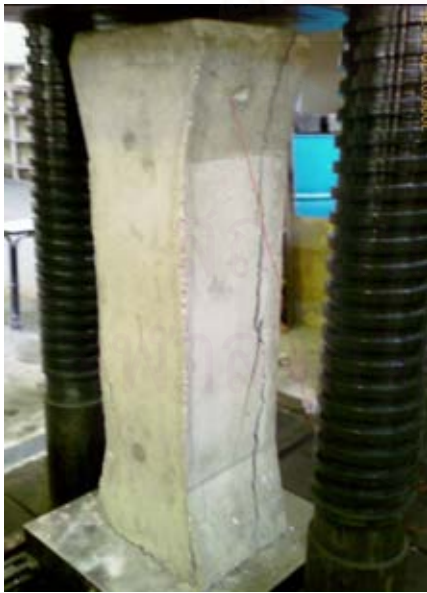
รูปที่ 3.106 แสดงการวิบัติของเสาตัวอย่างที่ 4
