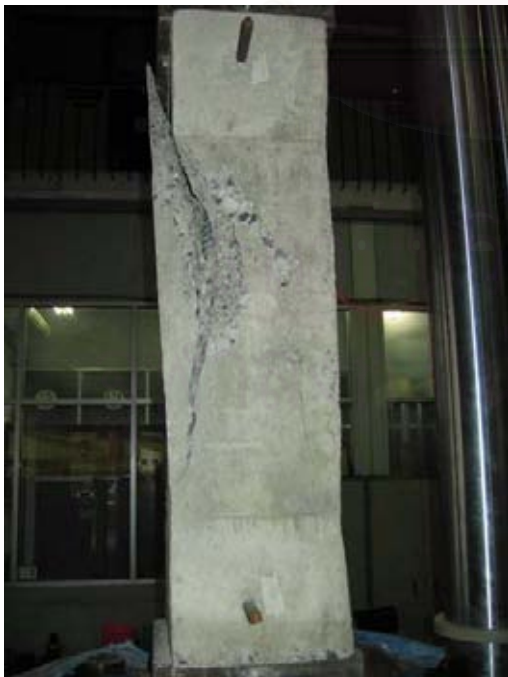
รูปที่ 3.86 แสดงการวิบัติของตัวอย่างเสาหมายเลข 16
