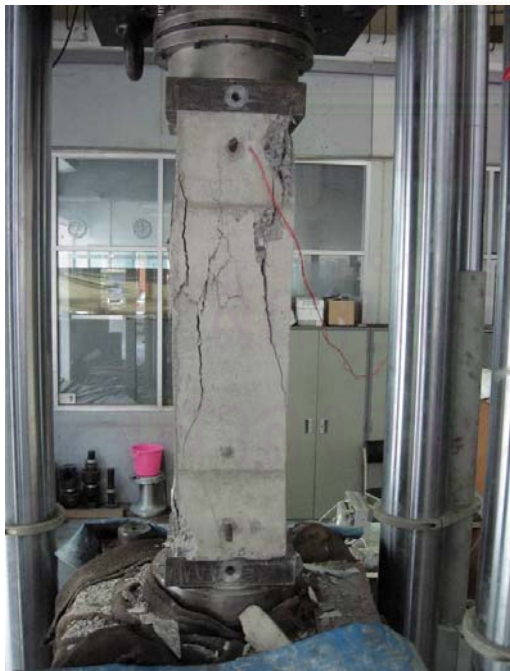
รูปที่ 3.70 แสดงการวิบัติของตัวอย่างเสาหมายเลข 7
