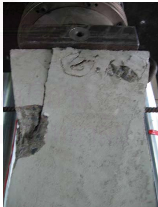
รูปที่ 3.71 แสดงการเริ่มเกิดการcrackของตัวอย่างเสาหมายเลข 8
