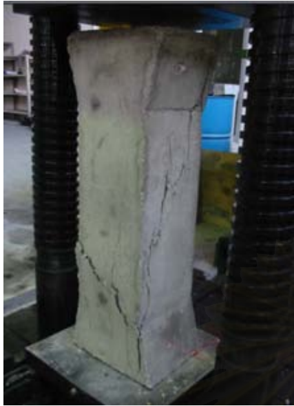
รูปที่ 3.108 แสดงการวิบัติของเสาตัวอย่างที่ 5
