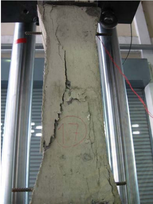
รูปที่ 3.88 แสดงการวิบัติของตัวอย่างเสาหมายเลข 17 รูปที่ 3.89 แสดงการวิบัติของตัวอย่างเสาหมายเลข 18
