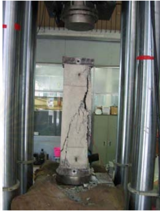
รูปที่ 3.82 แสดงการวิบัติของตัวอย่างเสาหมายเลข 14
