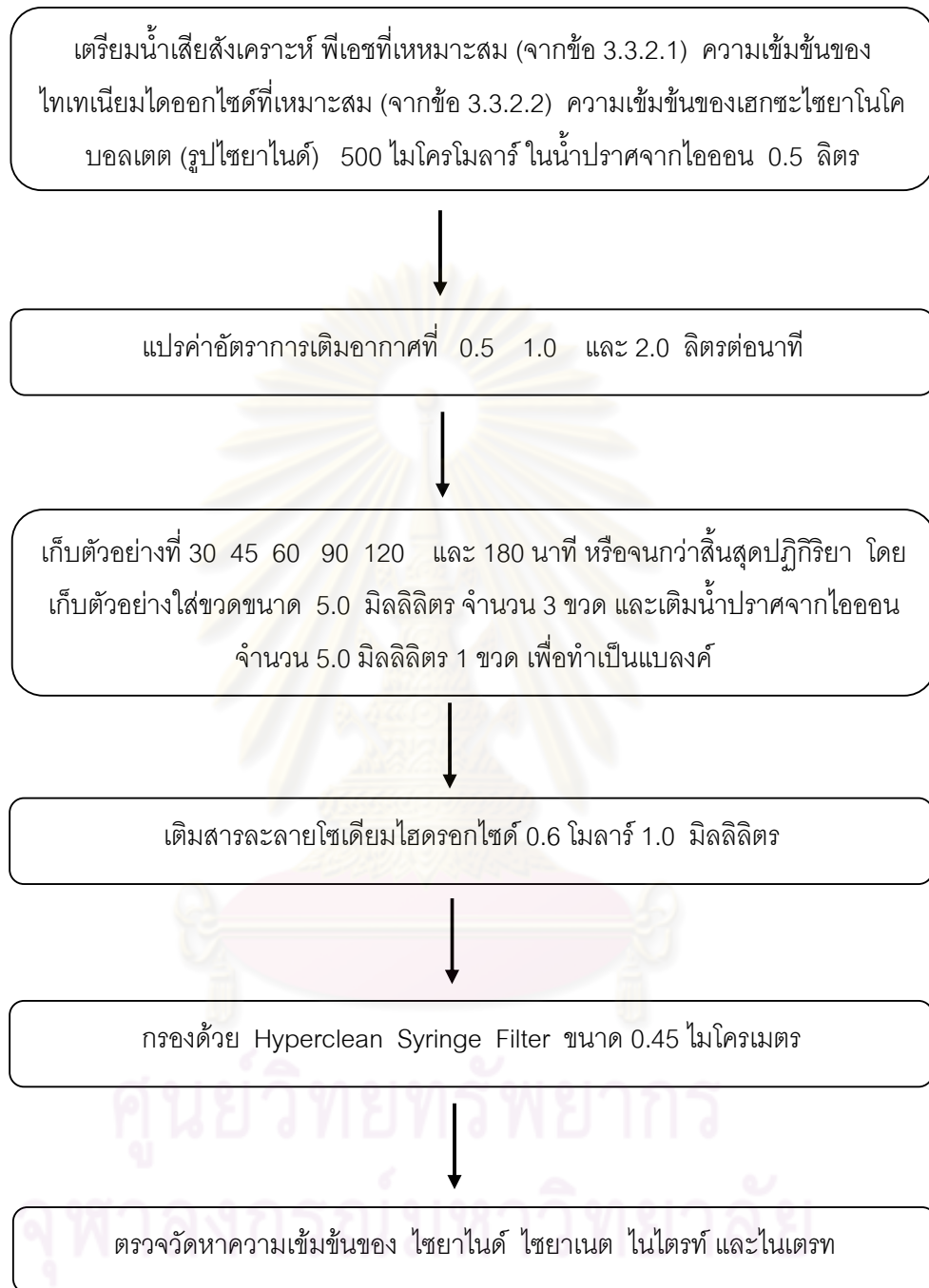
รูปที่ 3-8 แผนผังขั้นตอนการทดลองที่ 3.3.2.3
