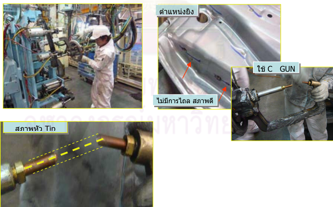
รูปที่ 4.23 การตรวจสอบหัวทิป และลักษณะจุดเชื่อมในช่วงต้นของกระบวนการ
