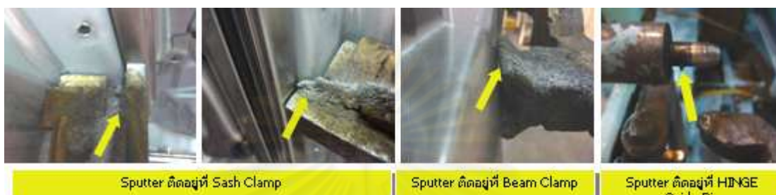
รูปที่ 4.24 ลักษณะ JIG ที่มี SPATTER ติดอยู่
