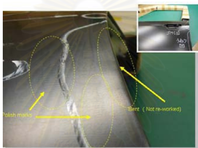
รูปที่ 4.31 ตัวอย่างชิ้นส่วนอะไหล่ที่ทำการซ่อมแล้วยอมรับไม่ได้
