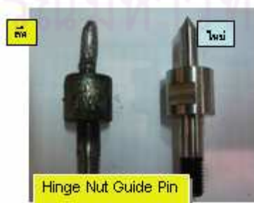
รูปที่ 4.26 ลักษณะ PIN เก่าที่สึกหรอ (ด้านซ้าย) และ PIN ใหม่ (ด้านขวา)
