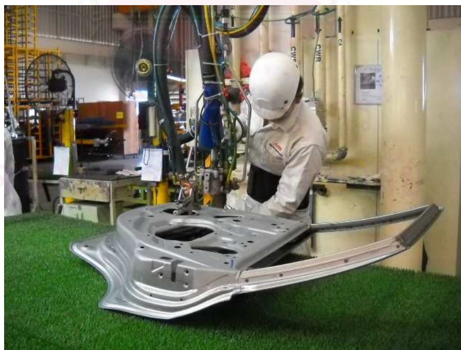
รูปที่ ง.2 ทดลองเชื่อมประกอบชิ้นส่วนอะไหล่ประตู่
