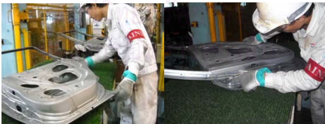
รูปที่ 4.34 พนักงานตรวจสอบคุณภาพชิ้นส่วนอะไหล่ประตูหลังกระบวนการพับขอบ
