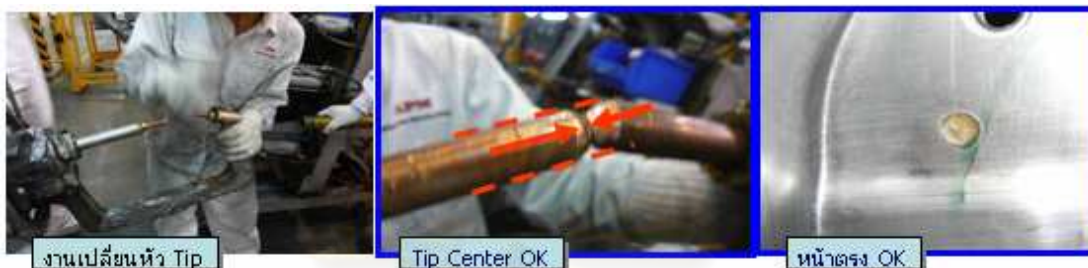
รูปที่ 4.22 ลักษณะหัวทิปที่อยู่ในศูนย์กลาง
