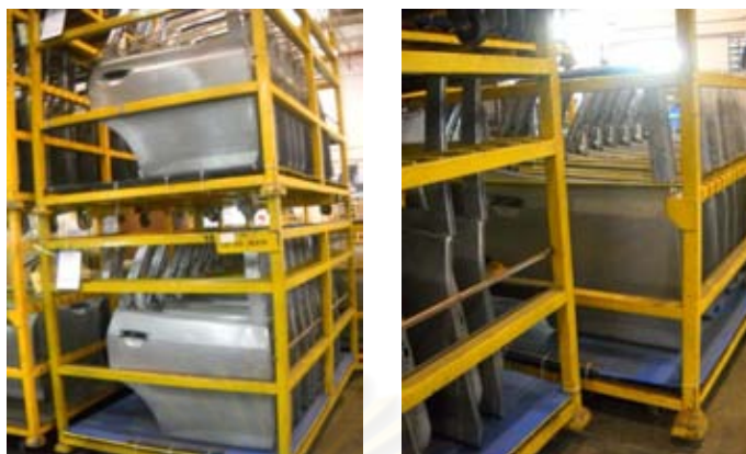
รูปที่ 4.37 การบรรจุชิ้นส่วนอะไหล่ประตูลงใน Rack ที่เหมาะสม
