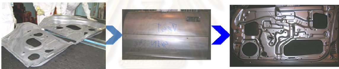
รูปที่ 3.10 จุดที่ต้องตรวจสอบหลังจากขึ้นรูปเสร็จแล้ว
