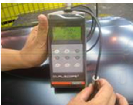
รูปที่ 3.12 การวัดค่าความหนาสี ED
