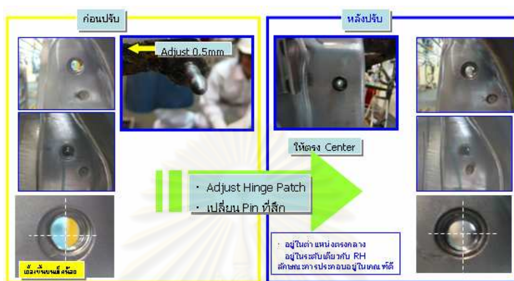
รูปที่ 4.27 เปรียบเทียบก่อนและหลังปรับปรุงตำแหน่งบานพับ และ PIN ที่ล็อกหรือ
