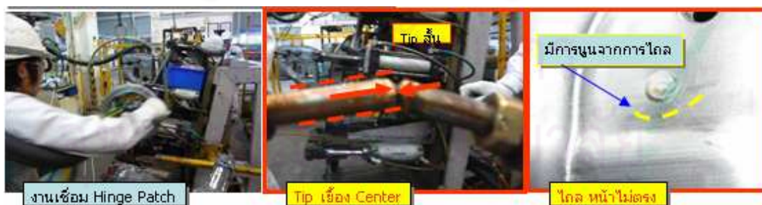
รูปที่ 4.21 ลักษณะหัวทียบที่เยื้องศูนย์กลาง
