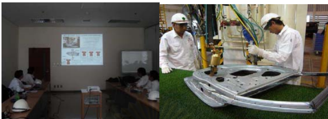
รูปที่ 4.17 การอบรมวิธีการเชื่อมหลังขั้นตอนการพับขอบที่ถูกต้อง
