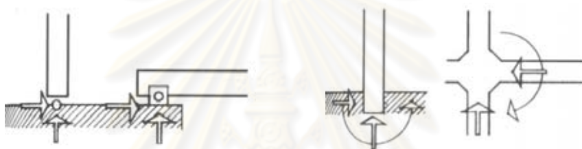
ภาพที่ 2-17 แสดงลักษณะของข้อต่อแบบหมุดและข้อต่อแบบแข็งหรือยึดแน่นตามลำดับ (ซิงและ อาดัม, 2545)
