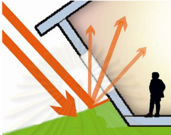
ภาพที่ 5 -28 แสดงรูปแบบผนังที่ควบคุมแสงจากภายนอกที่เข้ามามีคุณภาพ
