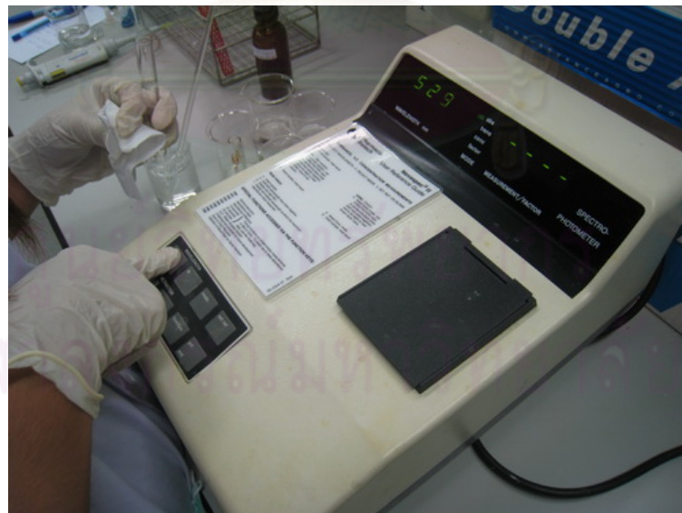
รูปที่ ก13 การวิเคราะห์หาปริมาณโครเมียมเฮกซะวาเลนต์ด้วยเครื่อง UV-Spectro photometer
