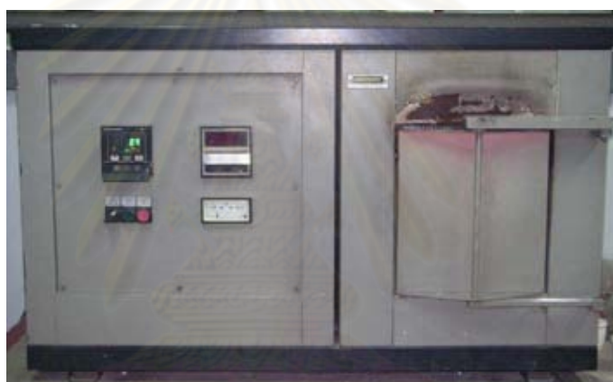
รูปที่ 3.4 เตาเผาไฟฟ้า Nabertherm รุ่น D 2804 Lilienthal/Bremen
