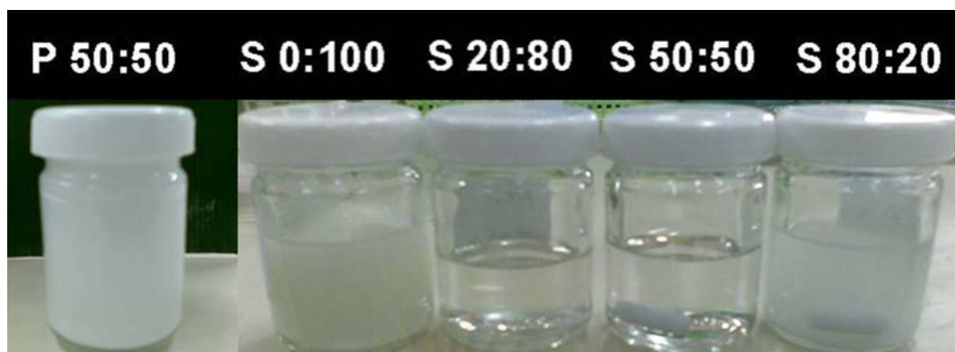
รูปที่ 4.1 ลักษณะของสารแขวนลอย (S) และสารละลาย (P) หลังจากกวนผสมเป็นเวลา 1 ชั่วโมง
