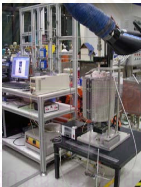
รูปที่ 3.7 ชุดทดสอบประสิทธิภาพของเซลล์เชื้อเพลิงชนิดเซลล์เดี่ยว
