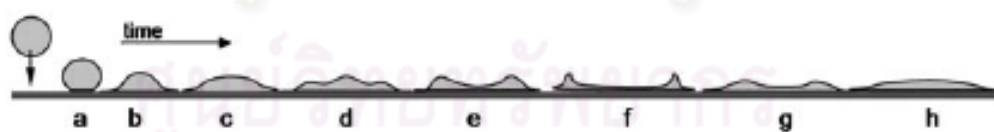
รูปที่ 2.16 การแผ่กระจายของหยดของสารละลายลงบนชั้นสเตรต
