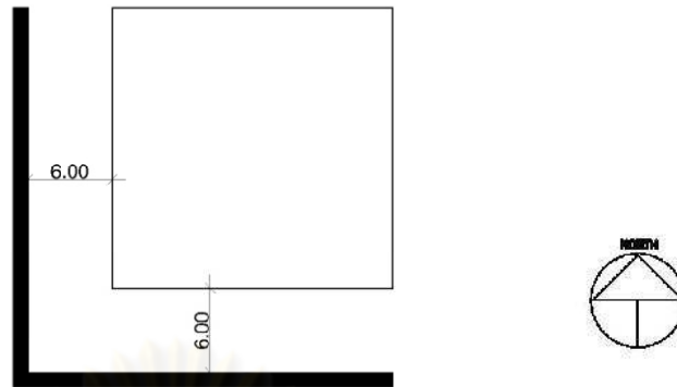
รูป 3.19 กรณีที่ดินมีแนวอาคารข้างเคียง 2 ด้านประชิดมุมที่ดินด้านทิศใต้-ตะวันตก
