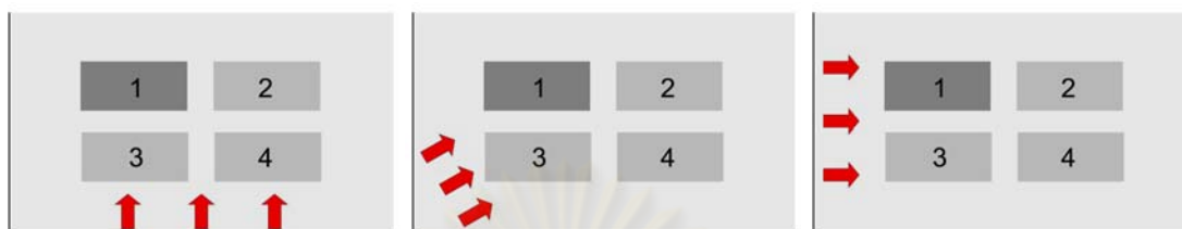
ภาพที่ 4.59 แสดงทิศทางของลมภายนอก ที่ไหลเข้าสู่อาคาร กรณีอาคารวางตำแหน่งที่ 1
