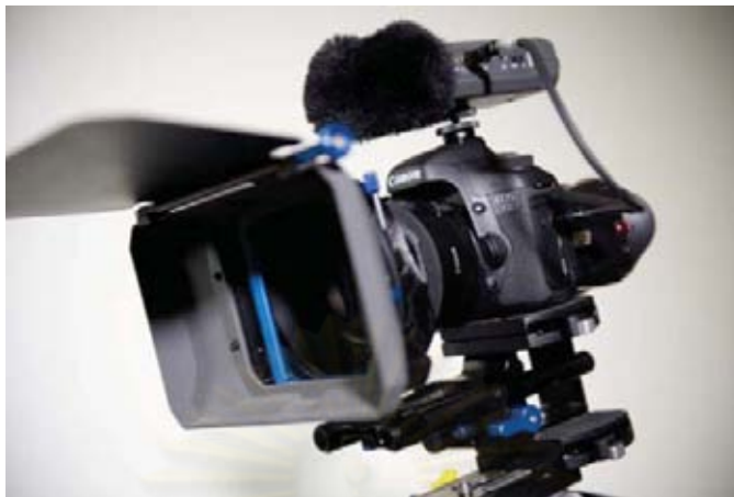
(รูปที่ 4.43 กล้องดิจิทัล DSLR ที่ใส่อุปกรณ์เสริมให้เหมาะกับการถ่ายทำ)
