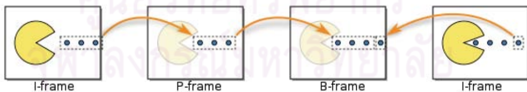
(รูปที่ 4.21 ขั้นตอนการทำงานของระบบ Inter-frame ในการสร้างเฟรมขึ้นมา)
