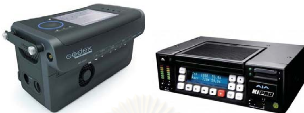
(รูปที่ 4.10 เครื่อง Codex, AJA KiPro สำหรับการจับภาพจากสัญญาณกล้องดิจิทัล)
