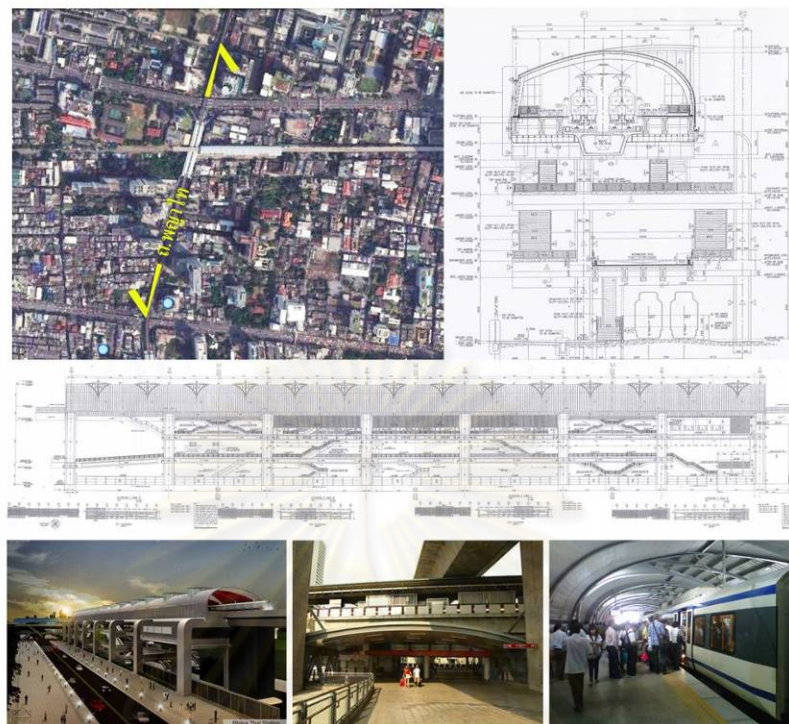
ภาพที่ 5.3 แสดงแนวโครงสร้างและรูปแบบสถานีพญาไทและการเชื่อมต่อกับสถานีบีทีเอส
