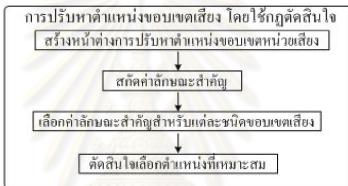
รูปที่ 4.2 กระบวนการทำงานของการปรับหาตำแหน่งขอบเขตเสียงโดยใช้กฎตัดสินใจ
