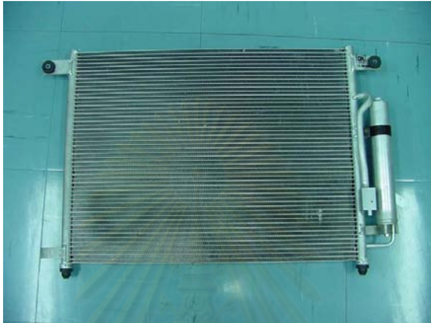
รูปที่ 4.9 รูปด้านหน้าของคอยล์ร้อนรถยนต์รุ่น T250 (ก่อนการประยุกต์ใช้เทคนิค QFD)
