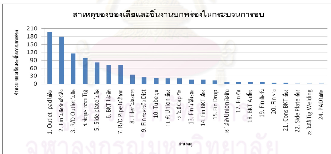
รูปที่ 1.2 แสดงสาเหตุของของเสียและชิ้นงานบกพร่องในกระบวนการอบคอยล์ร้อนรถยนต์ เดือนสิงหาคม 2551
