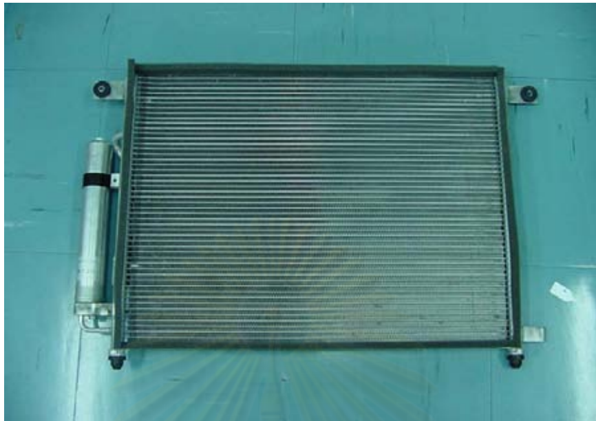
รูปที่ 4.11 รูปด้านหลังของคอยล์ร้อนรถยนต์รุ่น T250 (ก่อนการประยุกต์ใช้เทคนิค QFD)
