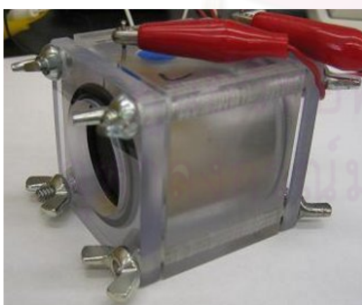
รูปที่ 2.15 เซลล์เชื้อเพลิงจุลชีพแบบภาชนะใบเดียวในรูปแบบต่างๆ (Rabaey และ Verstaete, 2005)
