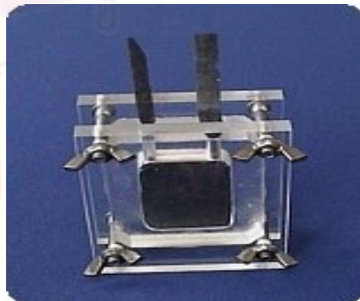
รูปที่ 2.15 เซลล์เชื้อเพลิงจุลชีพแบบภาชนะใบเดียวในรูปแบบต่างๆ (Rabaey และ Verstaete, 2005)
