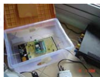
(ค) การต่อชุดเก็บข้อมูลความต่างศักย์ไฟฟ้ากับคอมพิวเตอร์และเซลล์เชื้อเพลิงจุลชีพ
