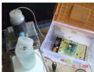
(ค) การต่อชุดเก็บข้อมูลความต่างศักย์ไฟฟ้ากับคอมพิวเตอร์และเซลล์เชื้อเพลิงจุลชีพ
