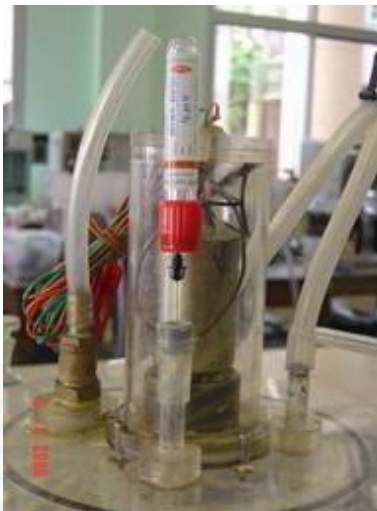
รูปที่ 3.9 การเก็บตัวอย่างก๊าซจากถังปฏิกรณ์
