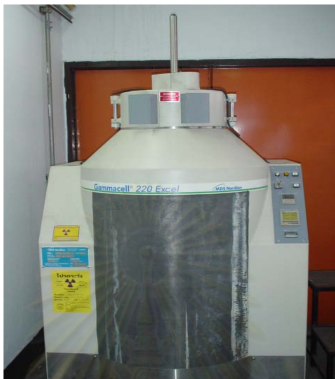
รูปที่ 3.1 เครื่องฉายรังสีแกมมาจาก Co-60 Gamma cell 220 excel สำนักงานปรมาณูเพื่อสันติ
