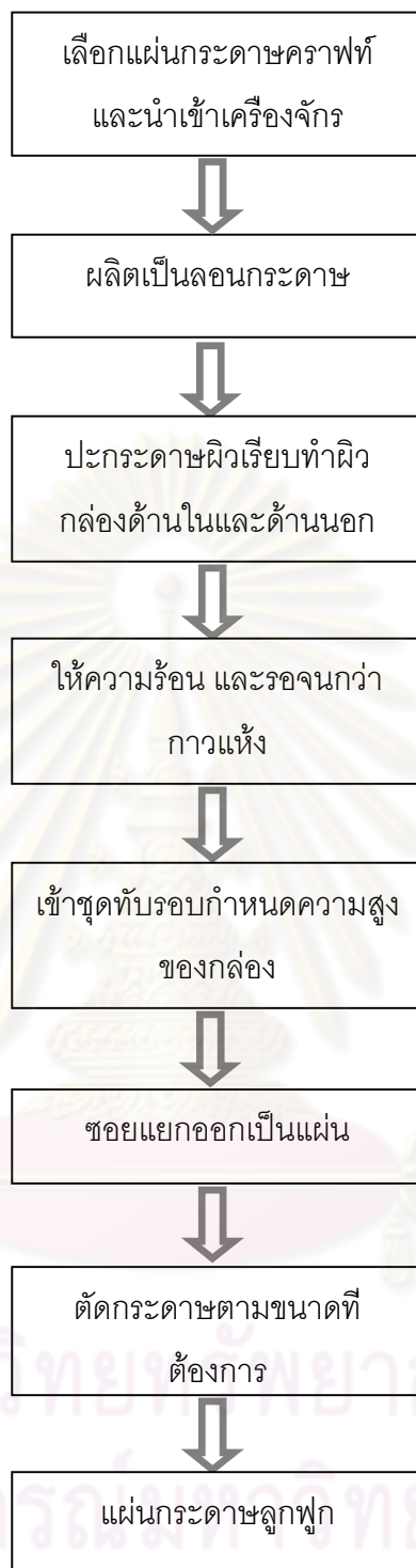
รูปที่ 1.4 ขั้นตอนการผลิตแผ่นกระดาษลูกฟูก
