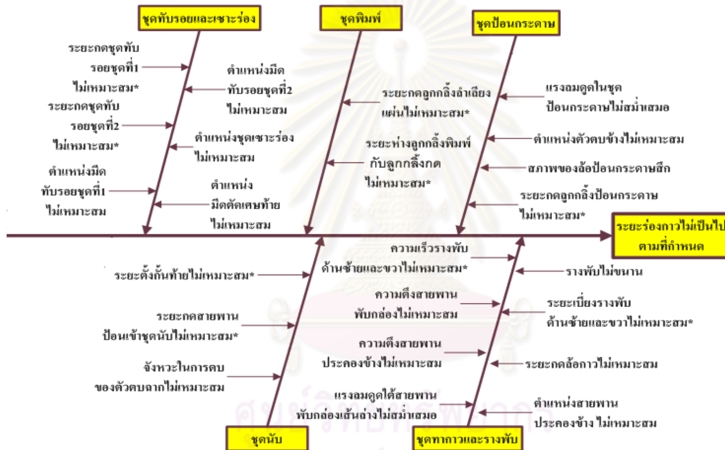
รูปที่ 3.9 แผนภาพสาเหตุและผลของปัญหาระยะเวลาการดำเนินงานไม่เป็นไปตามที่กำหนดในส่วนประกอบย่อยของเครื่องจักร
