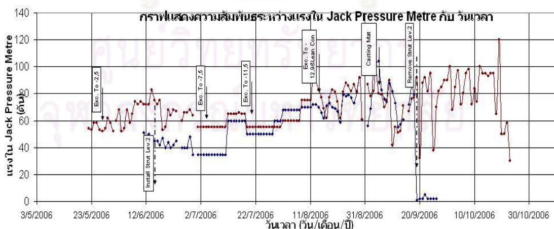
รูปที่ 3.24 แสดงข้อมูลการวัดค่าแรงในระบบค้ำยันด้านยาวกับผนังไดอะแฟรม โดย Pressure Gauge
