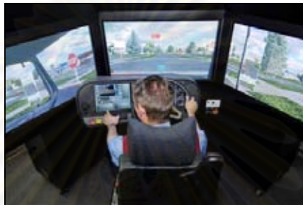
ภาพที่ 33 แสดงชุดฝึกหัดขับรถยนต์เสมือน (Drive Simulator) ช่วยสอนขับรถ โดยผู้ฝึกจะรู้สึกเสมือนว่ากำลังขับรถอยู่บนถนนจริงๆ
