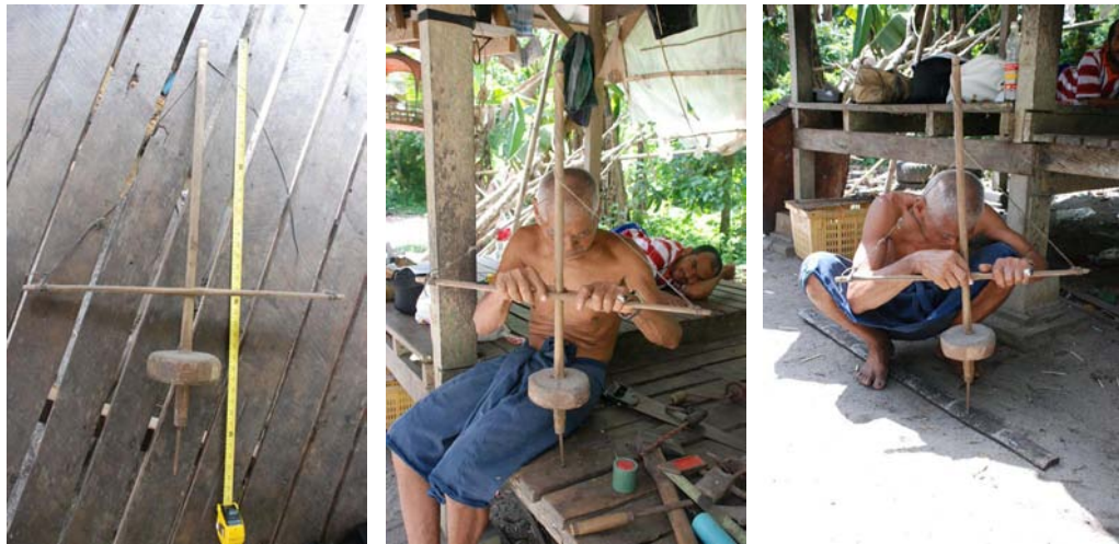
รูปที่ 3-167, 3-168, 3-169 ลักษณะของซึ่งและการทำงาน
