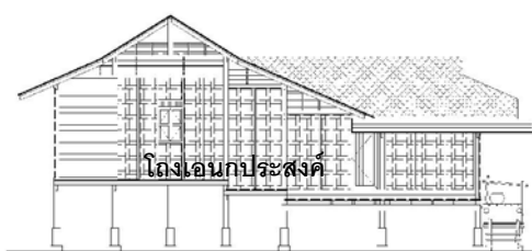
รูปที่ 3-94 รูปตัดตามขวางแม่เรือน แสดงพื้นที่ใช้สอยที่ต่างระดับของพื้นเรือน
