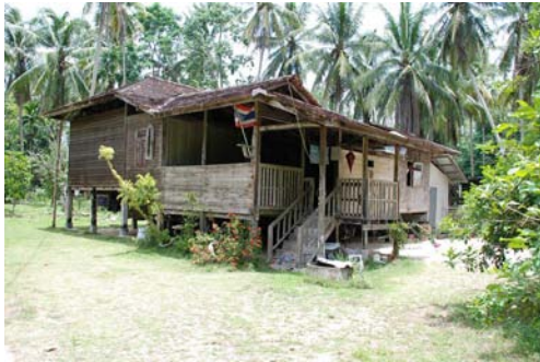
รูปที่ 3-379 แสดงการออกมุงเดี่ยวทรงซิก (ฉาก) และ ขยายชายหลังคาด้านเดียว หลังคาแม่เรือนทรงหล้าทู่ห้า (ปั้นหย่า) มุขหลังคาทรงหัวกะโหลกเล็ก (จั่วมะนิลา)
