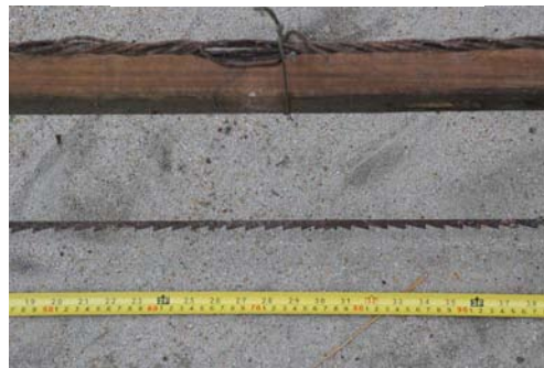
รูปที่ 3-160 ใบเลื่อยแกแซะจะแบ่งเป็น 2 ด้านเท่ากันและหันไปหาผู้เลื่อยในแต่ละด้าน
