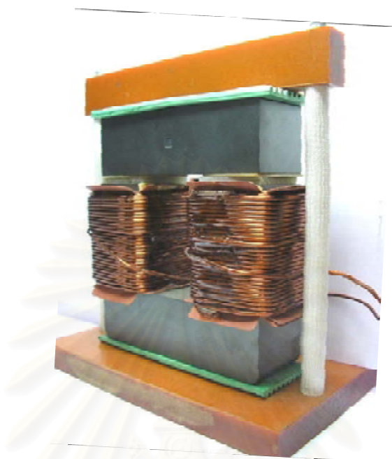
รูปที่ ค.5 ภาพถ่ายของตัวเหนี่ยวนำไหมดปกติขนาด 4 mH
