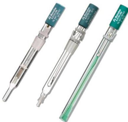
ภาพที่ 2.5 ซิลเวอร์-ซิลเวอร์คลอไรด์อิเล็กโทรดที่ใช้ในงาน
