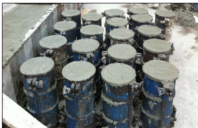
ภาพที่ 3.3 แสดงการเก็บตัวอย่างคอนกรีตรูปทรงกระบอกที่ทดสอบกำลังอัด
