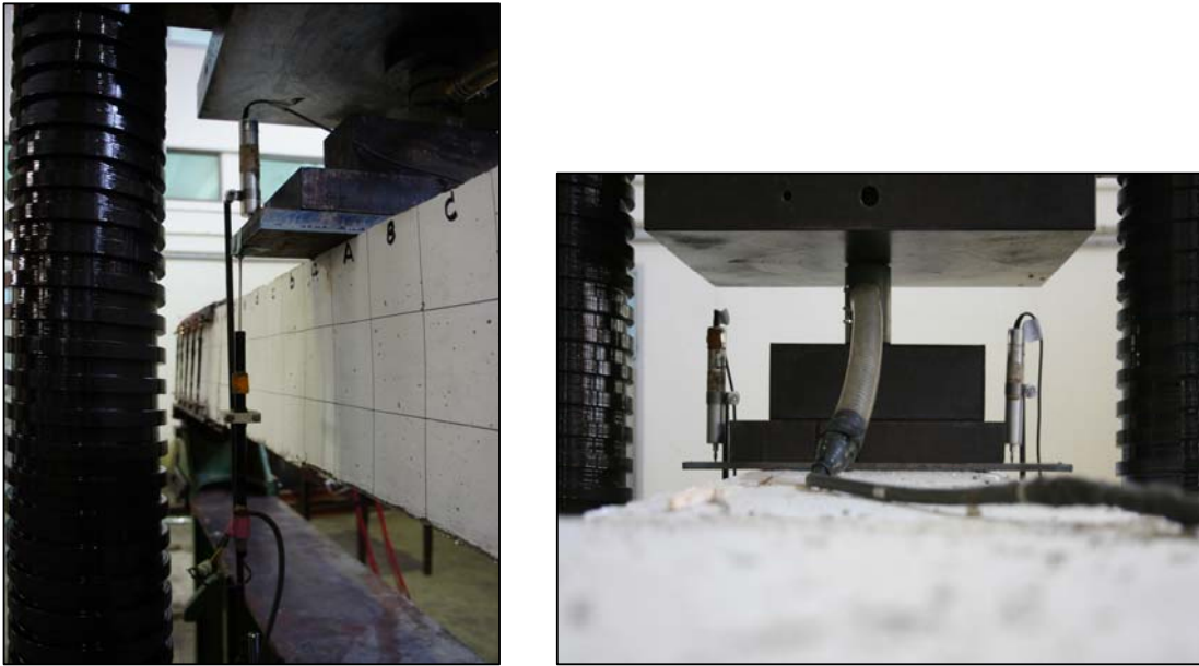
ภาพที่ 3.12 ตำแหน่งติดตั้งเครื่องวัดระยะการเคลื่อนที่
