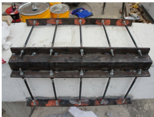
ภาพที่ 1.2 ส่วนประกอบของกรงเหล็กเสริมหุ้มภายนอก (steel cages)
