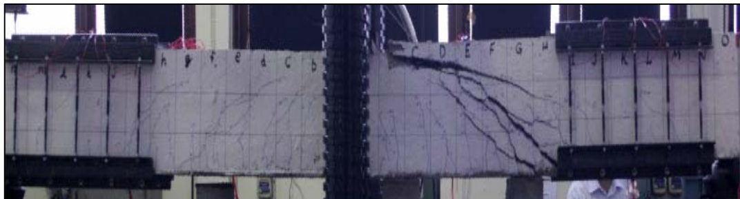
(ฉ) ที่ระยะการเคลื่อนที่ด้านข้างเท่ากับ 35 มม. สิ้นสุดการทดสอบตัวอย่าง S-SC2
