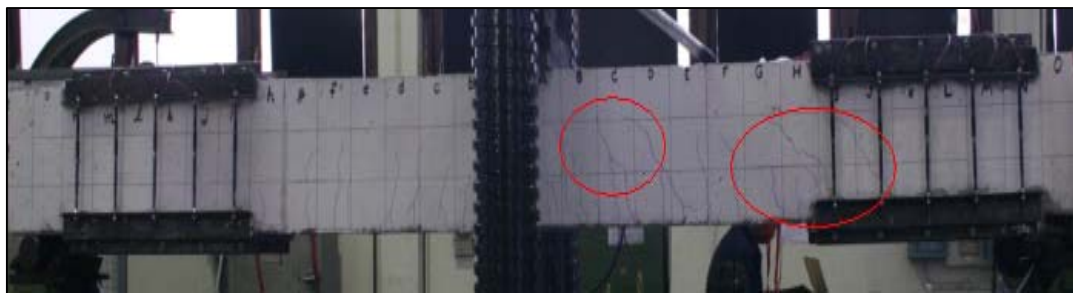
(ค) รอยแตกร้าวทแยงเพิ่มขึ้นอย่างเห็นได้ชัดที่แรงกระทำทางด้านข้างเท่ากับ 186.6 กิโลนิวตัน
