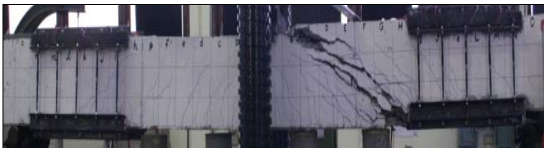
(ฉ) ที่ระยะการเคลื่อนที่ด้านข้างเท่ากับ 35 มม. สิ้นสุดการทดสอบตัวอย่าง S-SC1
