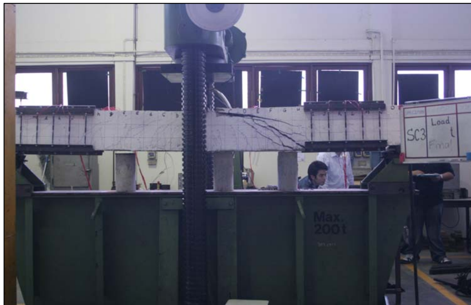
ภาพที่ 4.19 รูปแบบการวิบัติของตัวอย่าง S-SC2 หลังการทดสอบ
