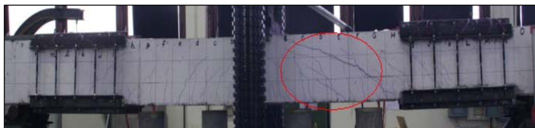
(ข) รอยแตกร้าวที่กำลังรับแรงกระทำทางด้านข้างสูงสุดเท่ากับ 234.2 กิโลนิวตัน ของตัวอย่างทดสอบ S-SC1
