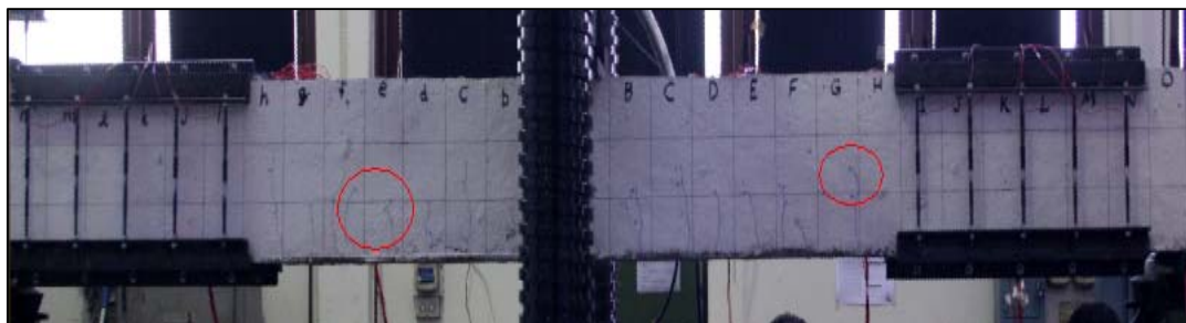
(ข) เริ่มมีรอยแตกร้าวทแยงที่แรงกระทำทางด้านข้างเท่ากับ 127.9 กิโลนิวตัน
