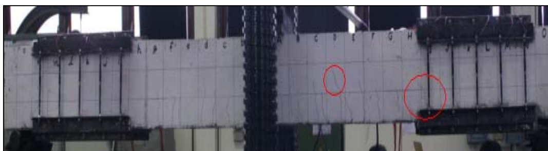
(ข) รอยแตกร้าวแบบเฉือนเริ่มแรกที่แรงกระทำทางด้านข้างเท่ากับ 127.4 กิโลนิวตัน ของตัวอย่างทดสอบ S-SC1
