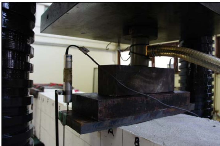
ภาพ ที่ 3.11 การติดตั้งอุปกรณ์ให้แรงกระทำทางด้านข้างและอุปกรณ์อ่านค่าแรงกระทำ
