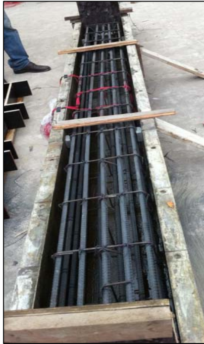
ภาพที่ 3.5 การยัดเรียงแบบหล่อตัวอย่างทดสอบ
