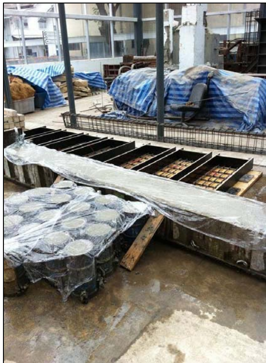
ภาพที่ 3.6 การใช้พลาสติกหุ้มตัวอย่างทดสอบและตัวอย่างรูปทรงกระบอก
