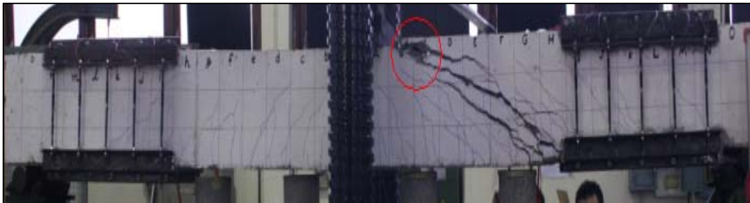
(จ) เกิดการแตกออกเป็นก้อนของคอนกรีตบริเวณรอยแตกร้าวลักษณะเป็นเส้นทแยงขนาดใหญ่ ที่ระยะการเคลื่อนที่เท่ากับ 33 มม.
