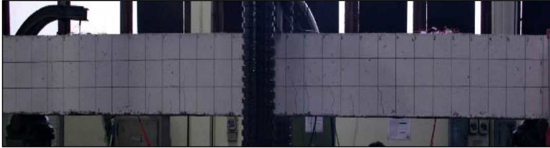
(ก) เริ่มมีรอยแตกร้าวในแนวตั้งฉากที่แรงกระทำทางด้านข้างเท่ากับ 78.2 กิโลนิวตัน
