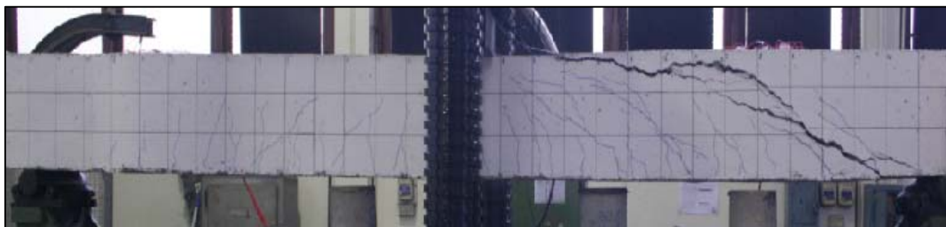
(ก) การวิบัติแบบเฉือนของตัวอย่างทดสอบ S-O
