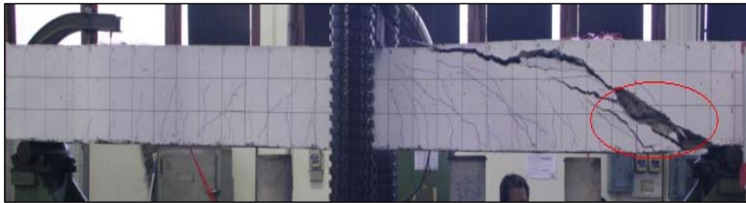
(จ) เกิดการแตกออกเป็นก้อนของคอนกรีตบริเวณรอยแตกกว้างลักษณะเป็นเส้นทแยงขนาดใหญ่ที่ระยะการเคลื่อนที่เท่ากับ 27 มม.
