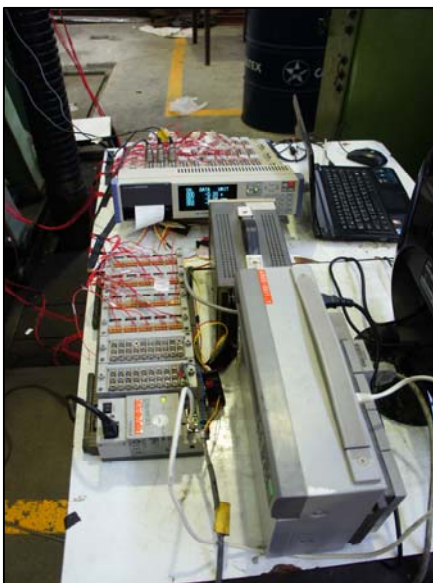
ภาพที่ 3.13 เครื่องเก็บข้อมูลและลักษณะการต่อสาย
