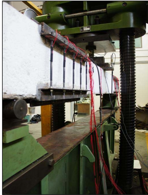
ภาพที่ 3.10 ตำแหน่งการติดตั้งวัดความเครียดบนเหล็กเสริมในกรงเหล็กหุ้มภายนอก
