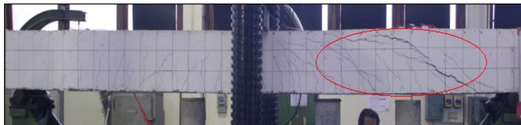
(ก) รอยแตกร้าวที่กำลังรับแรงกระทำทางด้านข้างสูงสุดเท่ากับ 227.7 กิโลนิวตัน ของตัวอย่างทดสอบ S-O
