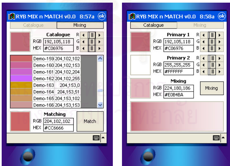
รูปที่ 5.2 แสดงโปรแกรมคอมพิวเตอร์ช่วยเทียบสีและผสมสีตัวอย่างบน PDA
