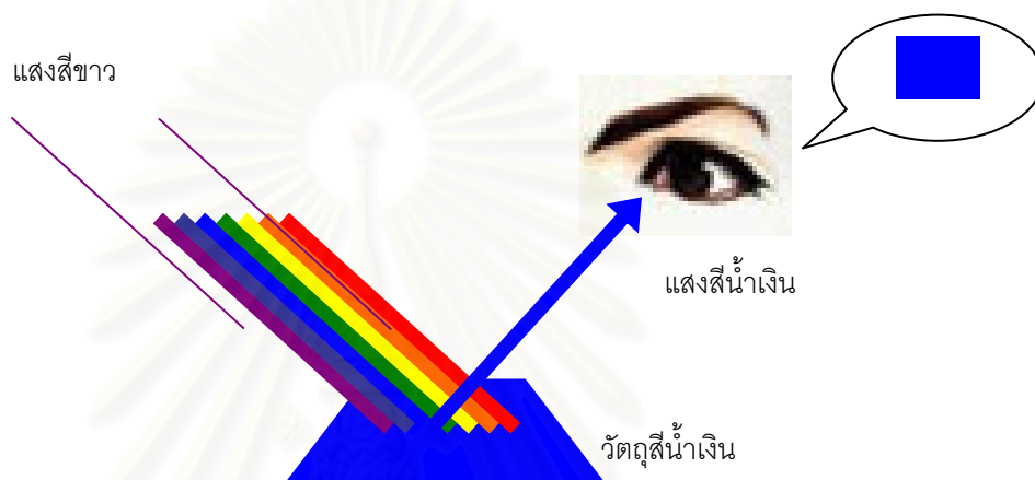
รูปที่ 2.2 แสดงการดูดซับคลื่นแสงโดยวัตถุแล้วสะท้อนคลื่นบางส่วนให้เห็น
