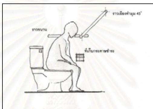
รูปที่ 6.26 แสดงลักษณะการติดตั้งราวจับทรงตัวในบริเวณสุขภัณฑ์
