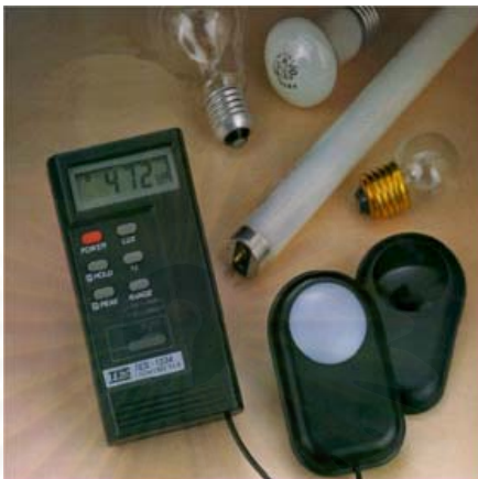
ภาพที่ 3.3 แสดงรูปเครื่องมือวัดแสงลักซ์มิเตอร์
