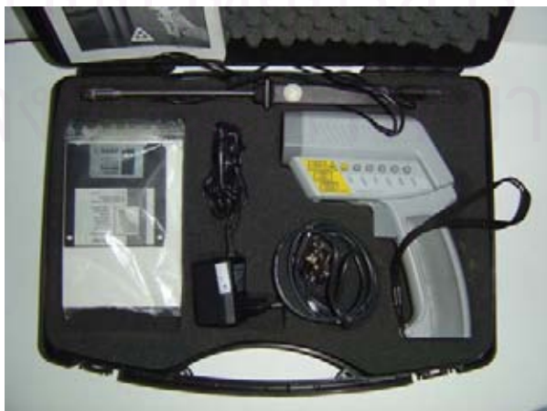
ภาพที่ 3.2 อุปกรณ์วัดอุณหภูมิพื้นผิวระยะไกล ชนิดปืน
