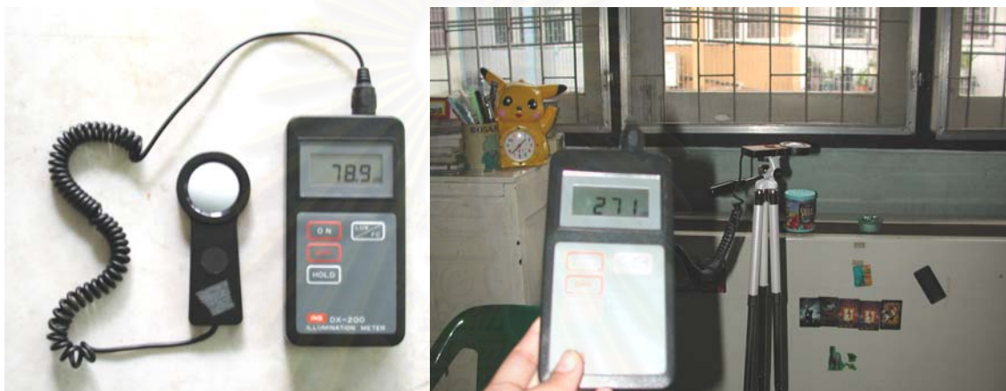
ภาพที่ 3-08 อุปกรณ์วัดค่าความส่องสว่างของพื้นที่
