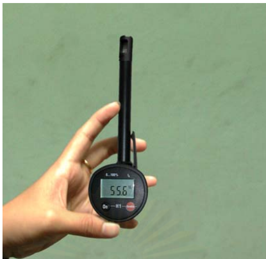
ภาพที่ 3-03 อุปกรณ์ Humidity measuring stick: Testo 605-H1
