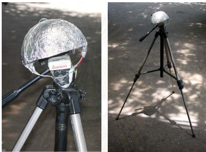
ภาพที่ 3-02 การติดตั้งอุปกรณ์ RH-Temp data logger: HOBO กลางแจ้ง
