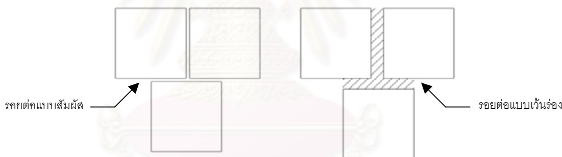
ภาพที่ ก.1 : ภาพแสดงรอยต่อแบบสัมผัส และรอยต่อแบบเว้นร่อง
