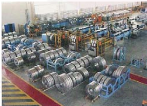
ภาพที่ 76 : ภาพแสดงการกองเก็บวัตถุดิบ และการผลิตชิ้นส่วนในระบบรีดเย็น
