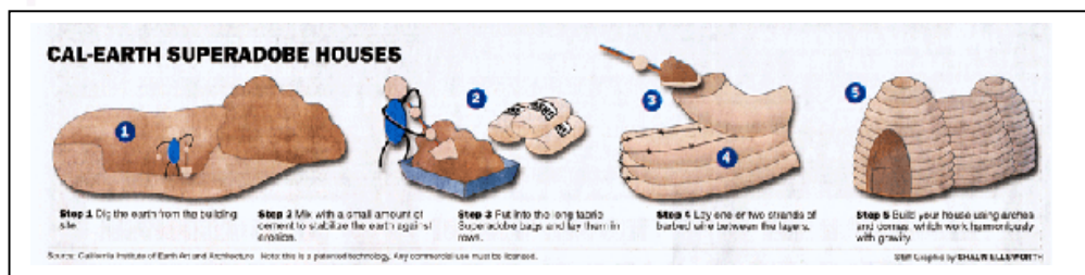
ภาพที่ 19 : ภาพแสดงกระบวนการในการก่อสร้างอาคารด้วยระบบ Super adobe
