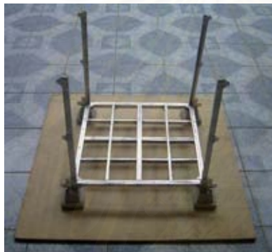
ภาพที่ 100 : ภาพแสดงการติดตั้งคานชอยรองรับพื้นอาคารด้วยข้อต่อPI2
