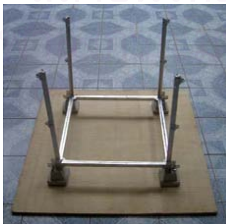
ภาพที่ 99 : ภาพแสดงการติดตั้งคานหลักของอาคาร ยึดติดกับตอม่อบนฐานราก
