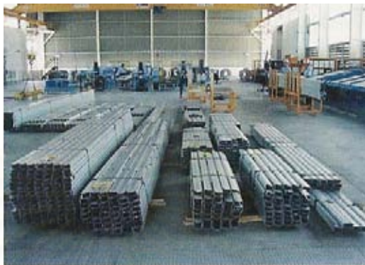
ภาพที่ 89 : ภาพแสดงการกองเก็บวัสดุแบบแยกประเภทตามรูปแบบเพื่อรอการขนส่ง
