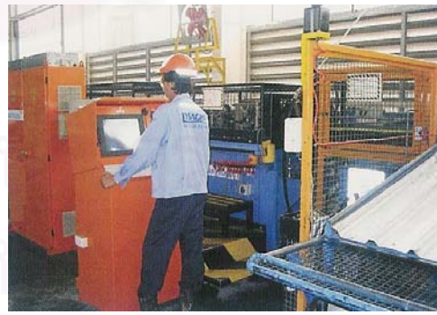
ภาพที่ 76 : ภาพแสดงการกองเก็บวัตถุดิบ และการผลิตชิ้นส่วนในระบบรีดเย็น
