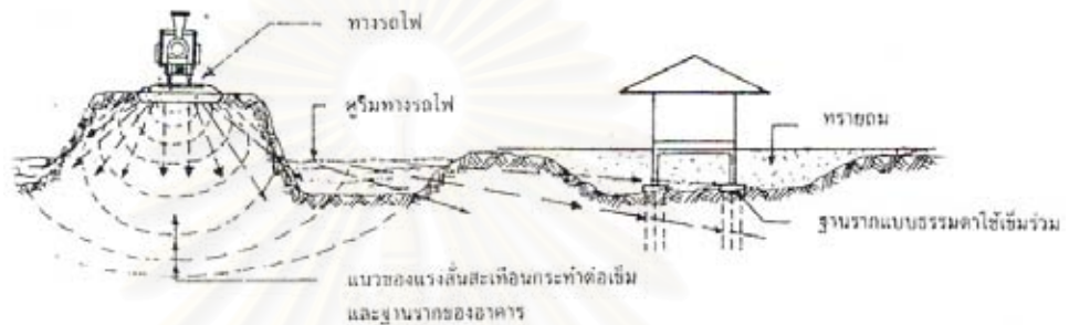
ภาพที่ 57 : ภาพแสดงผลกระทบจากแรงสั่นสะเทือนที่เกิดจากทางรถไฟ กระทำต่อฐานรากของอาคาร
