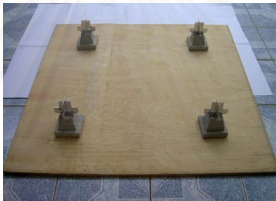
ภาพที่ 95 : ภาพแสดงการติดตั้งฐานราก และตอม่ออาคารในพื้นที่ที่ไม่มีการคดผิวด้วยคอนกรีต
