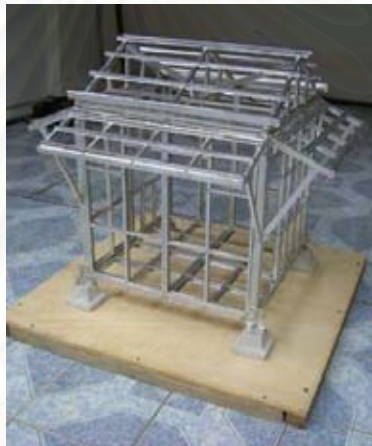
ภาพที่ 108 : ภาพแสดงแบบจำลองโครงสร้างอาคารตัวอย่าง ที่ประกอบติดตั้งเสร็จสมบูรณ์
