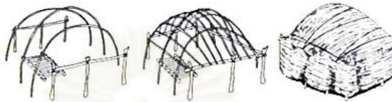
ภาพที่ 3 : ภาพแสดงเทคนิคการก่อสร้างอาคารด้วยวัสดุแบบดั้งเดิมสำเร็จรูป
