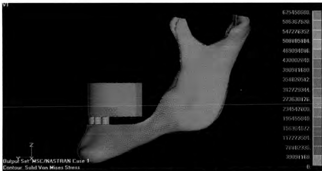
ภาพที่ 4.8 ด้านข้างของแบบจำลองไฟไนต์เอลิเมนต์กลุ่มที่ 2 ประกอบด้วยรากเทียมจำนวน 5 รากเทียมถูกฝังในบริเวณด้านหน้าของขากรรไกรเพื่อรองรับฟันปลอมชนิดไฮบริด ซึ่งปรากฏการกระจายของแรงเค้นภายในแบบจำลองหลังจากได้รับแรงบดเคี้ยวแสดงให้เห็นด้วยแถบสีต่างๆ
